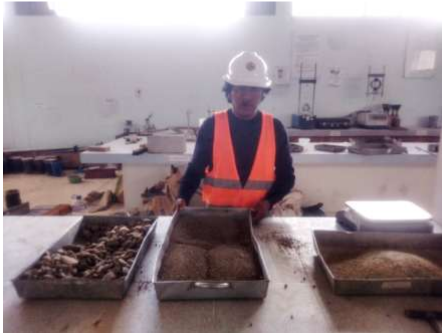
Fotografía 09. Mezcla de agregados fino y grueso
