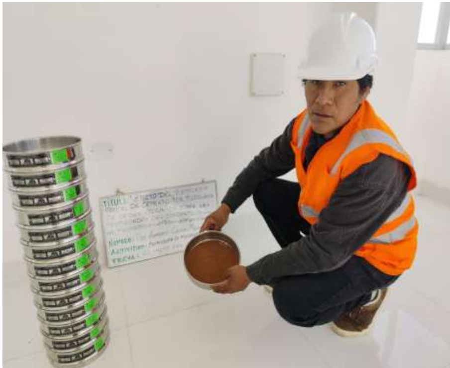
Fotografía 02. Tamizado de la puzolana
