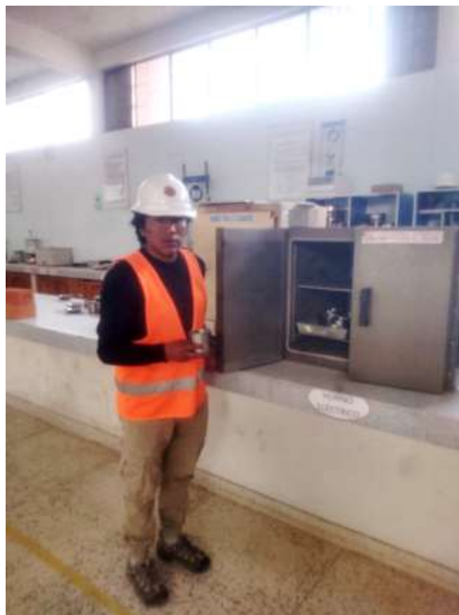
Fotografía 08. Introducción de agregados para medición de contenido de humedad
