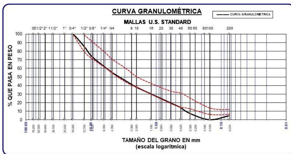
Figura 3. Características de la curva granulométrica de la muestra asfáltica de la Muestra 1 – “Av. Circunvalación Sur”
