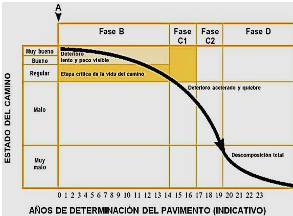
Figura 1 Estado de la vía sin mantenimiento
