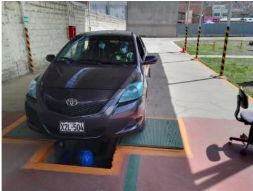
Imagen 07: Procesos de revisión de holguras de ruedas delanteras
