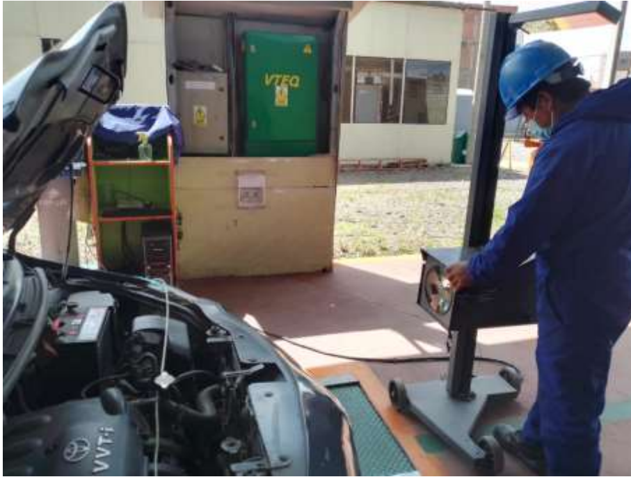
Imagen 11: Procesos de análisis de luces bajas y altas
