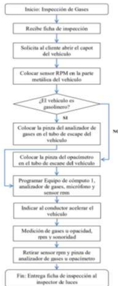
Figura 14: Propuesta del diagrama de flujo de inspección de gases
