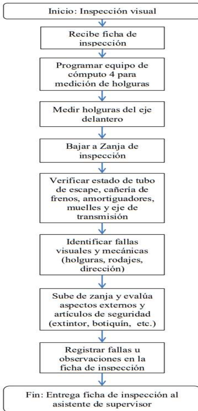
Figura 17: Propuesta de diagrama de flujo de inspección visual
