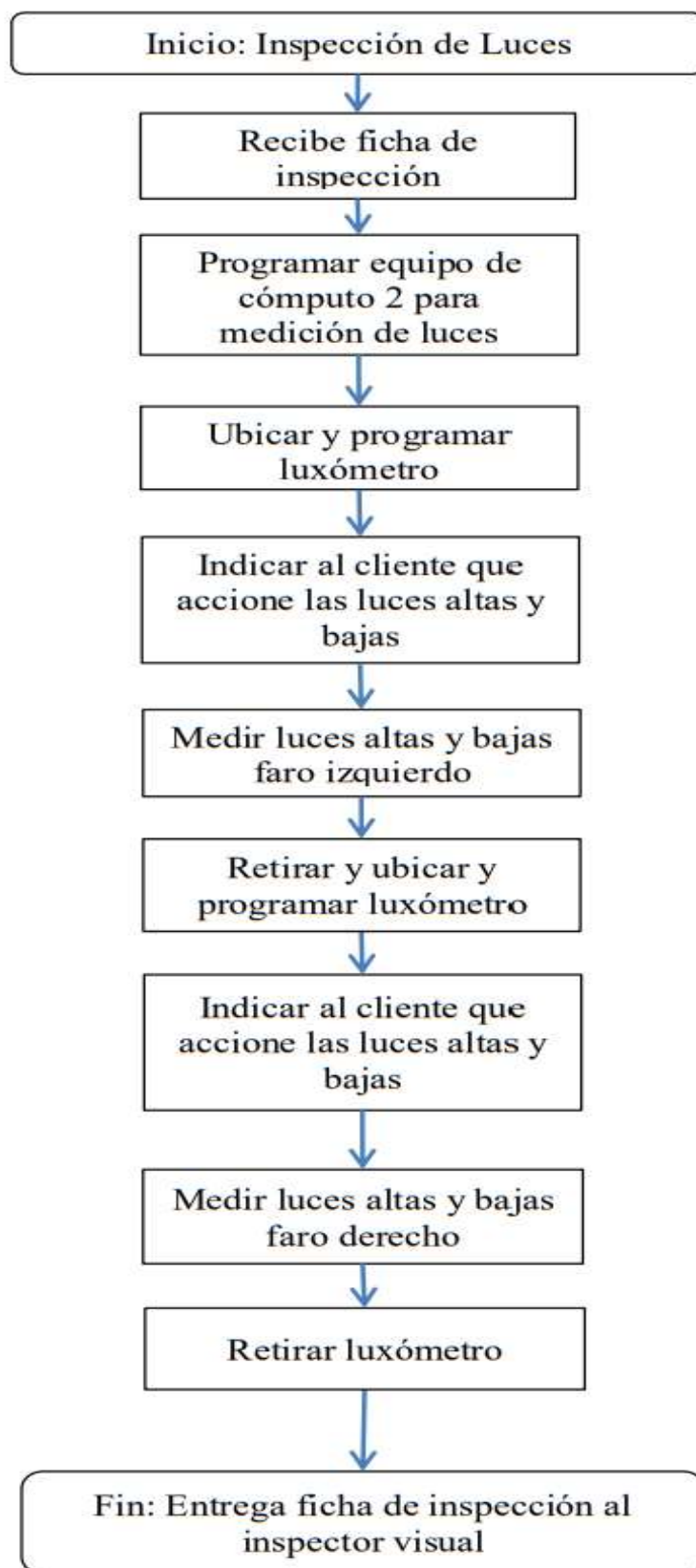
Figura 15: Propuesta del diagrama de flujo para la inspección de luces.
