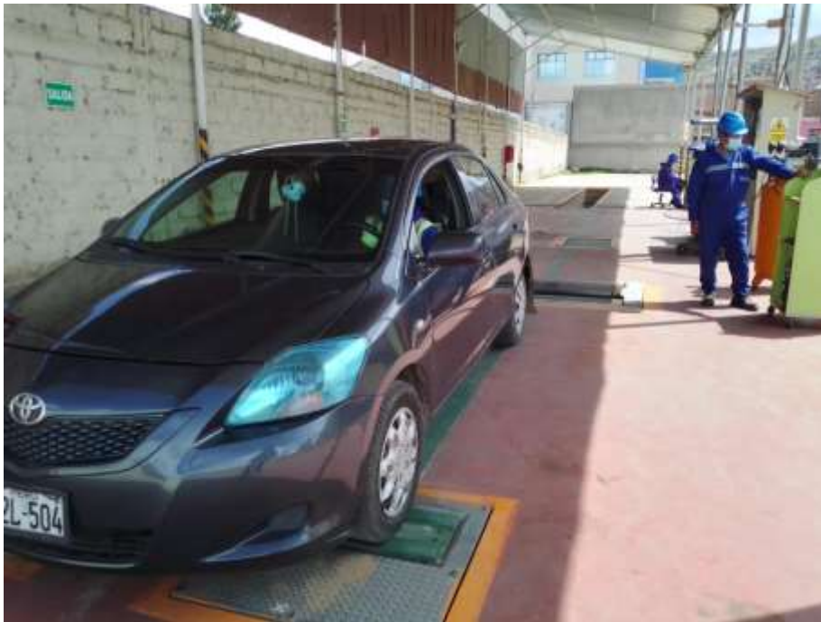
Imagen 17: Procesos de prueba de suspensión
