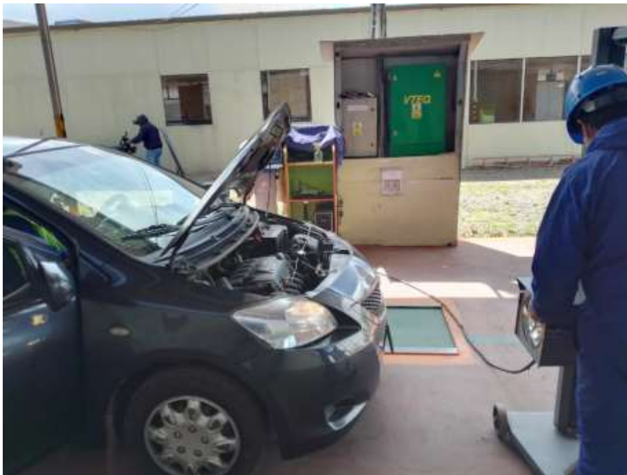
Imagen 12: Procesos de análisis de luces bajas y altas
