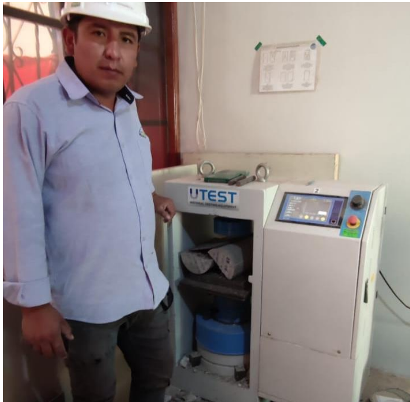
Fotografía 5. Ensayo de la resistencia a la tracción del concreto
