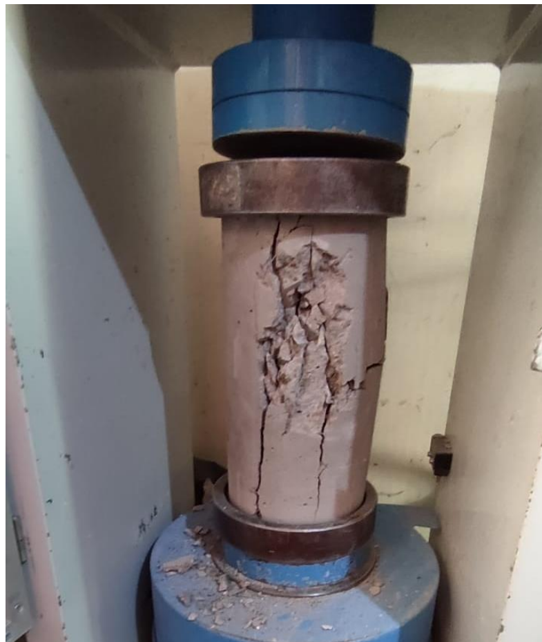
Fotografía 4. Rotura de la probeta
