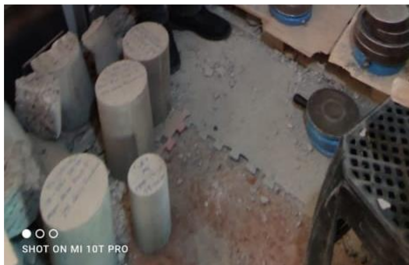
Elaboración de probetas cilíndricas
