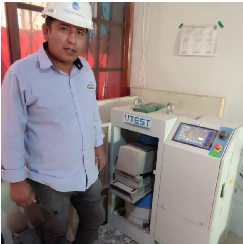
Fotografía 6. Ensayo de la resistencia a la flexión del concreto
