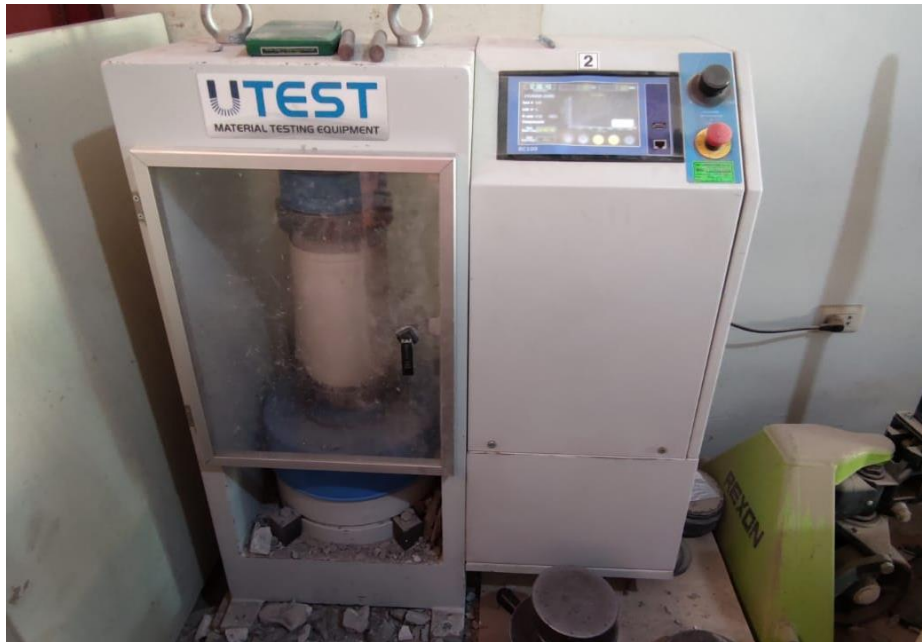
Fotografía 3. Prueba de resistencia a la compresión del concreto
