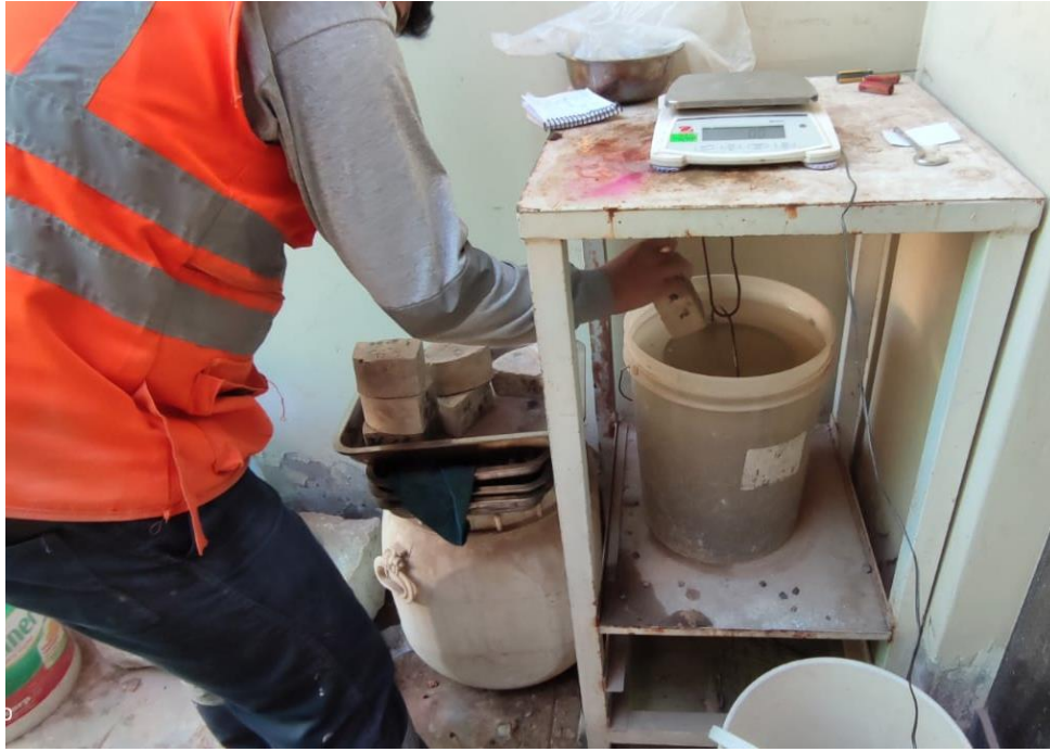
Fotografía 9. Peso suspendido de probetas de concreto
