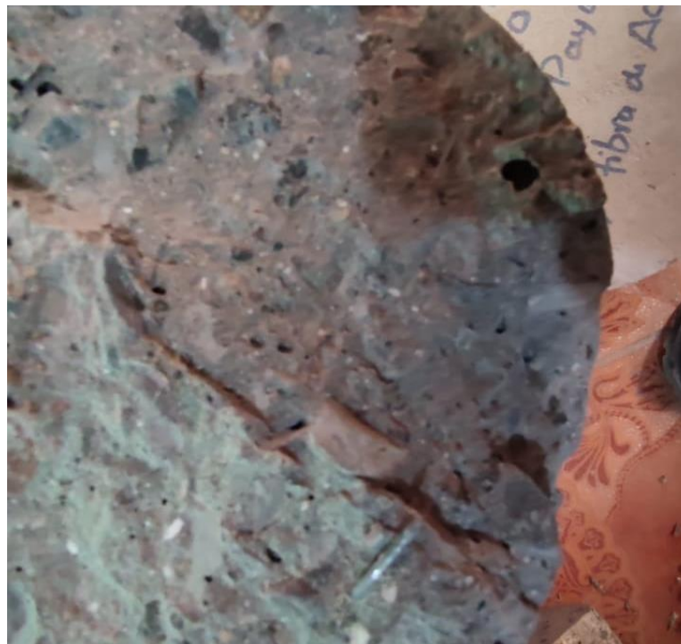
Fotografía 1. Concreto con adición de fibras de clavo reciclado
