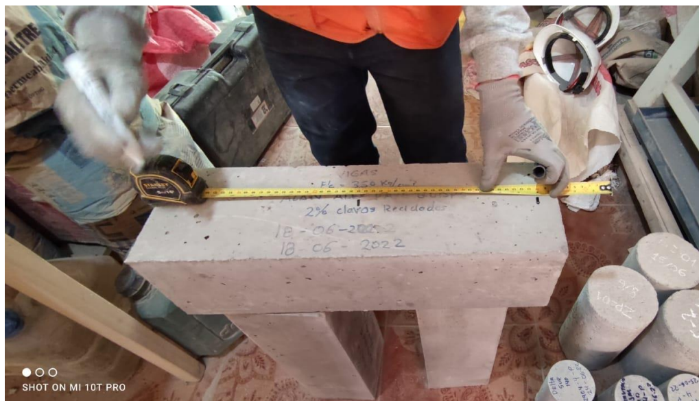
Fotografía 2. Dimensionamiento de las vigas de concreto para el ensayo a flexión
