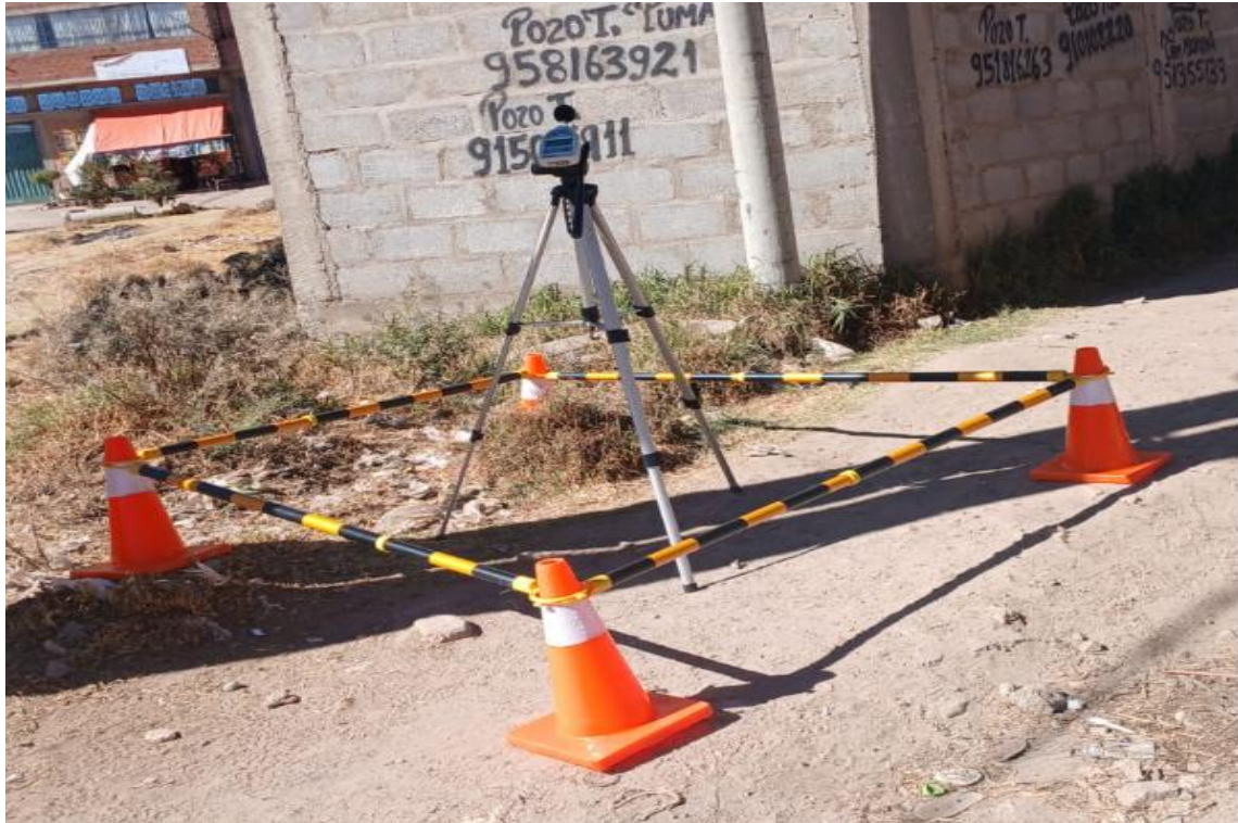
Fotografía 1. Monitoreo de Ruido Cámara de bombeo P1
