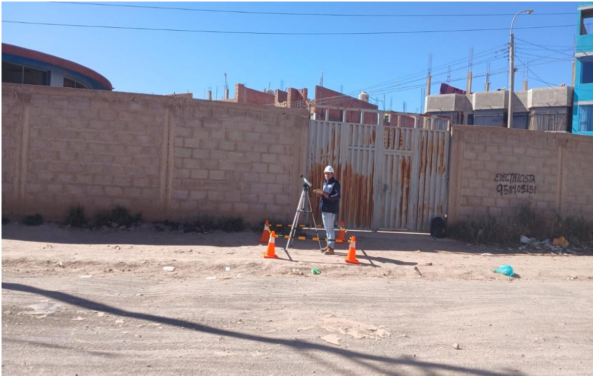
Fotografía 2. Monitoreo de Ruido Cámara de bombeo P2
