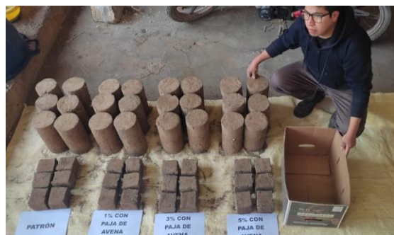
Fotografía 6. Transporte de adobes para los ensayos de roturas
