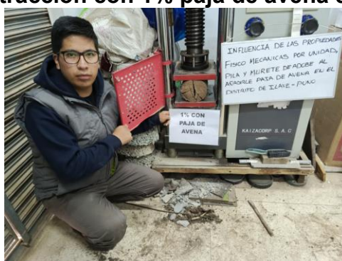
Figura 32. Ensayo de resistencia a la tracción de la muestra de unidad de adobe con 1% paja de avena
