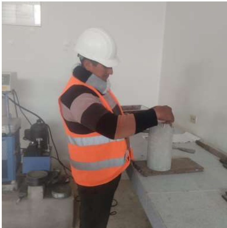
Fotografía 14. Medición de la briqueta.
