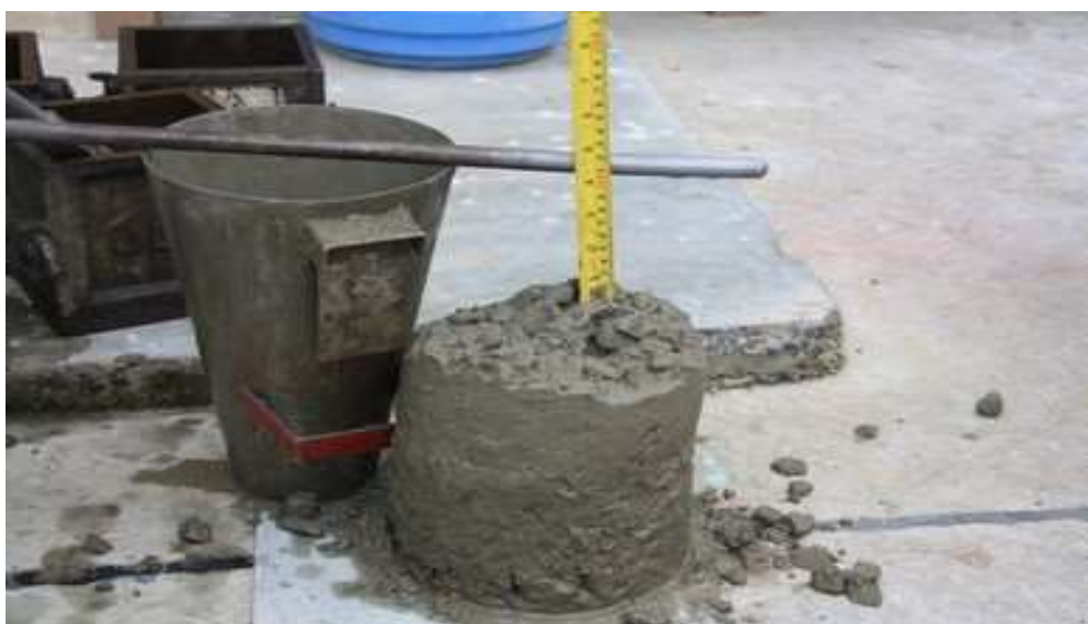
Ensayo del slump
