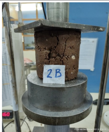
F-17 Ensayo de Resistencia a compresión
