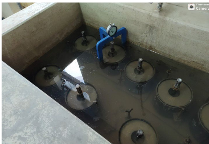
F-15 Ensayo de Capacidad soporte
