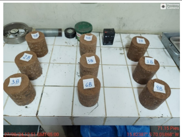
F-18 Ensayo de Resistencia a compresión
