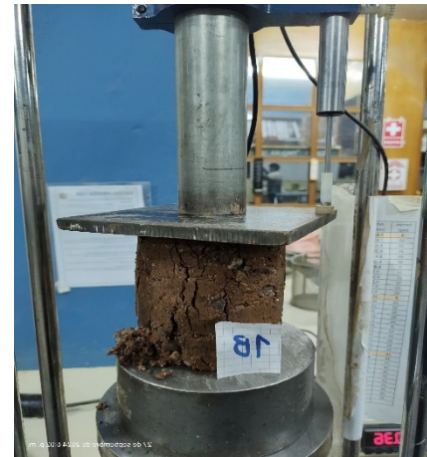
F-14 Ensayo de Resistencia a compresión
