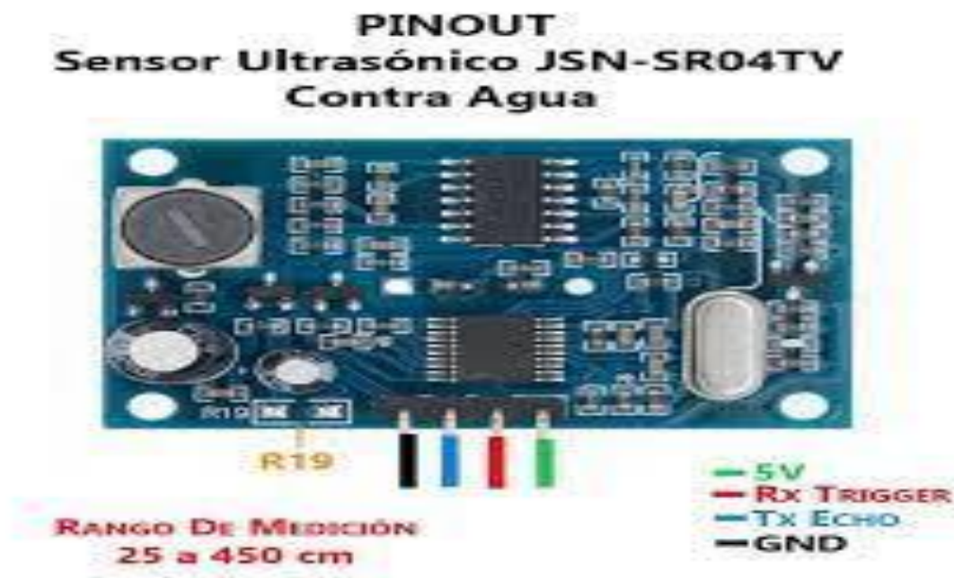
Configuración de sensor ultrasonido JSN-SR04T
