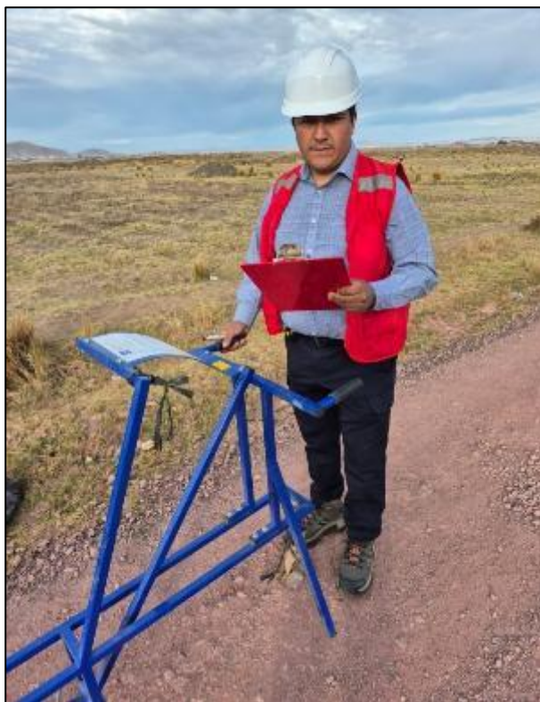
Fotografía 6. Verificación del desarrollo con el equipo Merlín.
