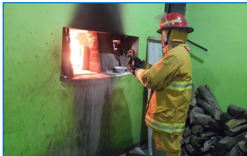
FOTOGRAFÍA 12. EXPOSICIÓN DE BRIQUETAS A TEMPERATURAS DE INCENDIO
