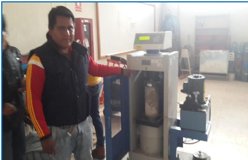
FOTOGRAFÍA 17. REGISTRO DE RESISTENCIA DEL CONCRETO
