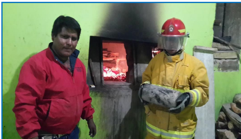
FOTOGRAFÍA 14. EXPOSICIÓN DE BRIQUETAS A TEMPERATURAS DE INCENDIO
