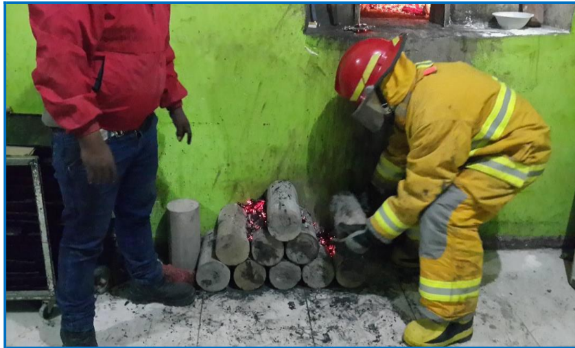
FOTOGRAFÍA 16. EXPOSICIÓN DE BRIQUETAS A TEMPERATURAS DE INCENDIO
