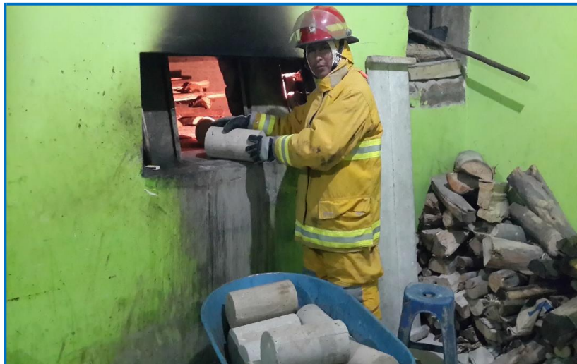
FOTOGRAFÍA 11. EXPOSICIÓN DE BRIQUETAS A TEMPERATURAS DE INCENDIO
