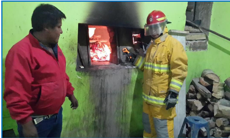
FOTOGRAFÍA 13. EXPOSICIÓN DE BRIQUETAS A TEMPERATURAS DE INCENDIO
