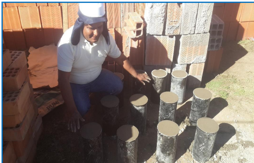
FOTOGRAFÍA 8. TRATAMIENTO DE BRIQUETAS DE CONCRETO
