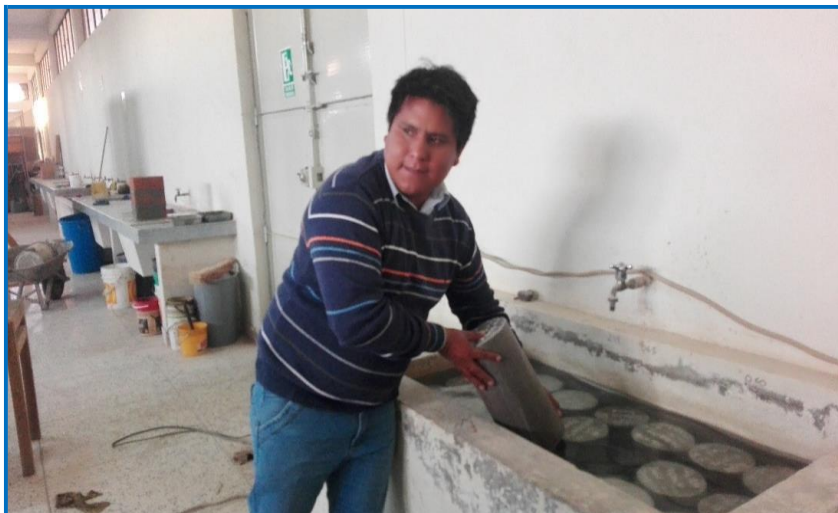
FOTOGRAFÍA 18. CURADO DE BRIQUETAS DE CONCRETO
