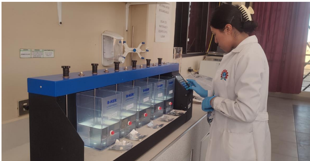
Fotografía 4. Equipo del test de jarras empleando coagulantes naturales a diferentes dosis.
