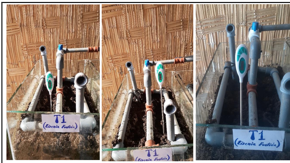
FOTO N° 9: Evaluación de la temperatura del sustrato del Biofiltro de lombrices
