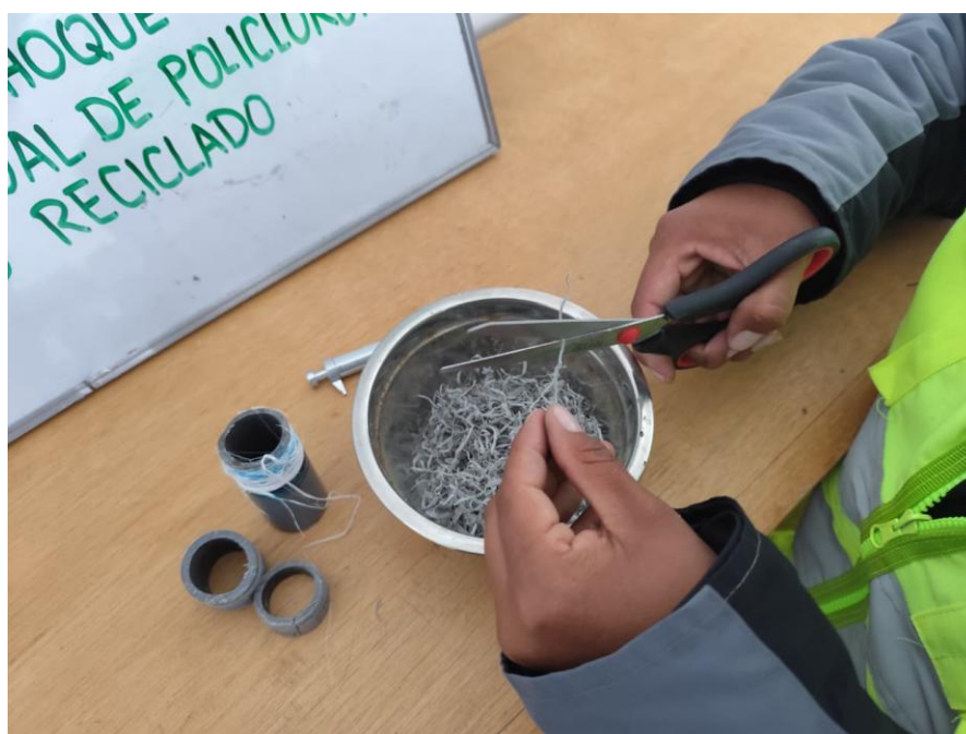
Fotografía 2. Corte de tiras de tuberías de PVC.
