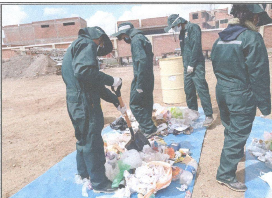
PROCEDIMIENTO DE MEZCLA Y BATIDO DE MUESTRAS REPRESENTATIVAS DE VIVIENDA Y COMERCIO
