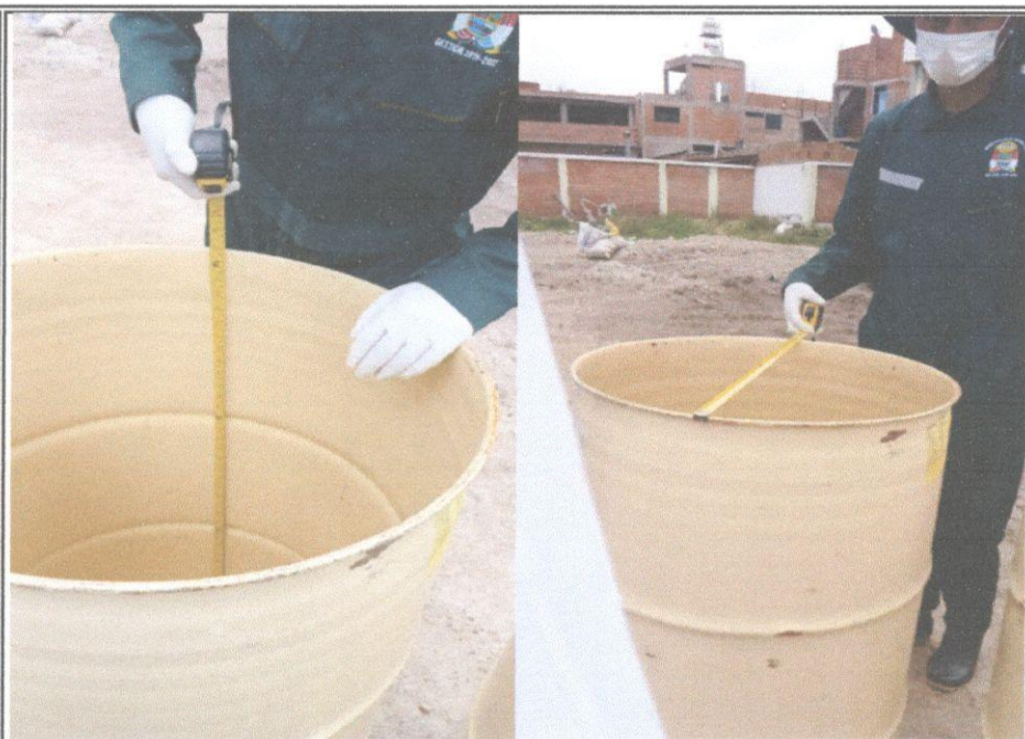
ETAPA DE SELECCIÓN DE MUESTRA REPRESENTATIVA; TOMA DE MEDIDAS DE CILINDRO
