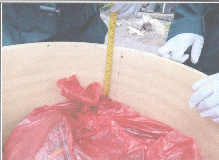
TOMA DE MEDIDAS DE ESPONJAMIENTO DESPUES DE ZARANDEO DE MUESTRAS DE COMERCIO EN CILINDRO
