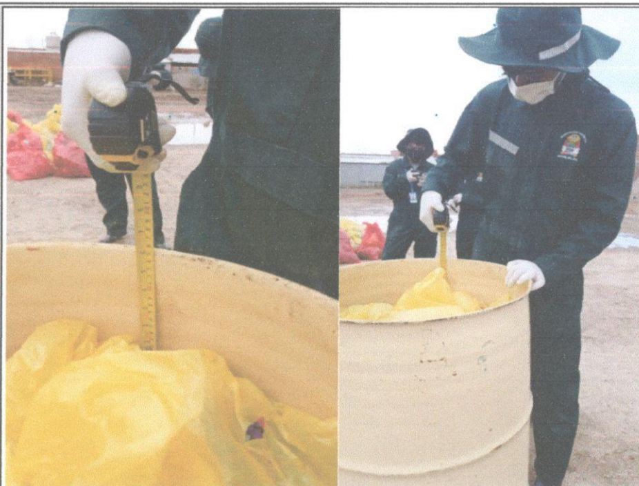
TOMA DE MEDIDAS DE ESPONJAMIENTO DESPUES DE ZARANDEO DE MUESTRAS DE VIVIENDAS EN CILINDRO
