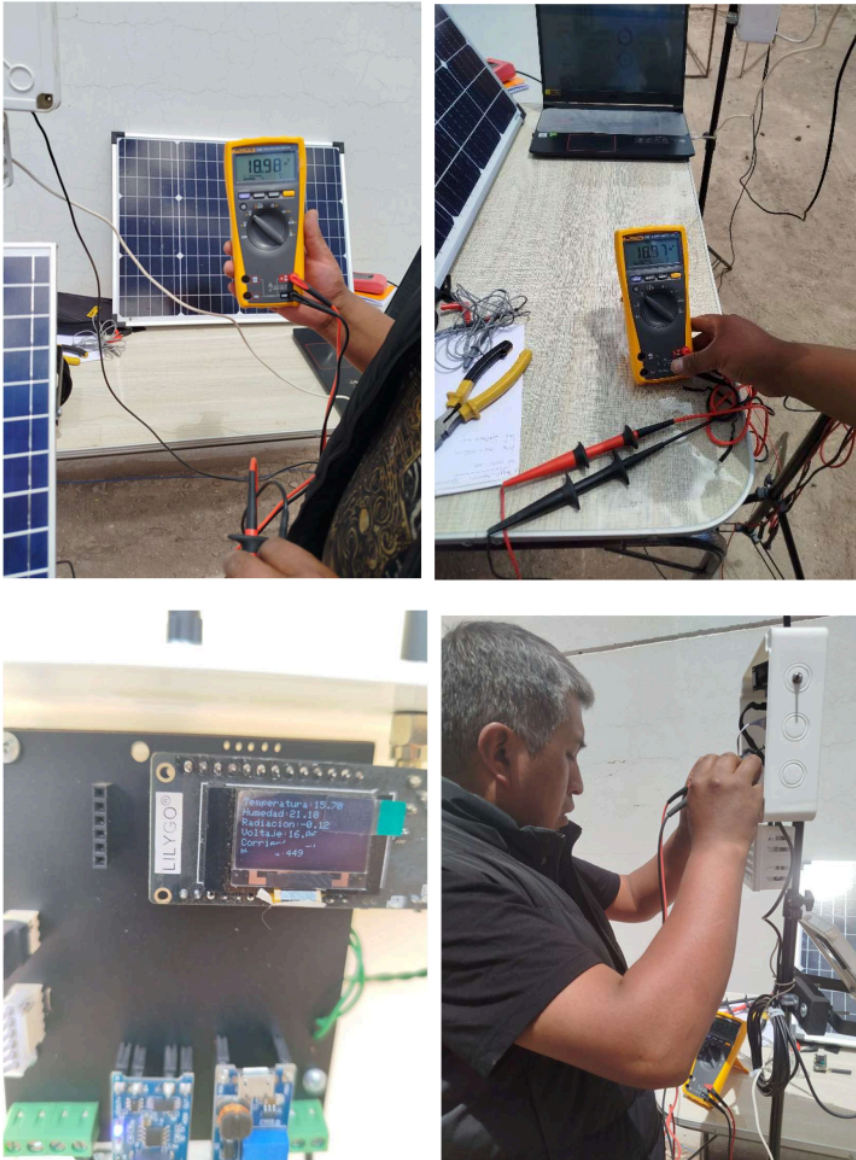
Muestras fotográficas: Tomas de muestras de voltaje y corriente con el multímetro Fluke 179 y el sistema propuesto.
