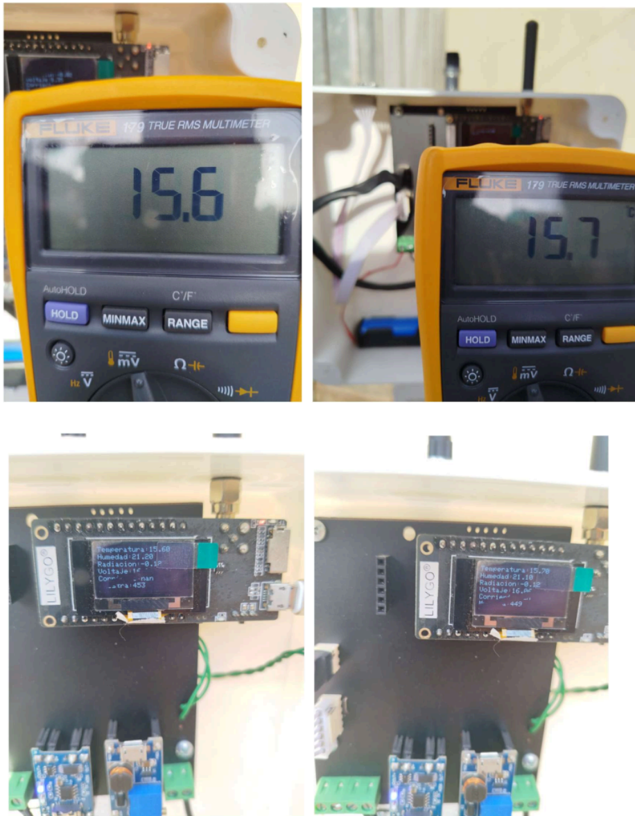
Muestras fotográficas: Tomas de muestras de temperatura con el multímetro Fluke 179 y el sistema propuesto.
