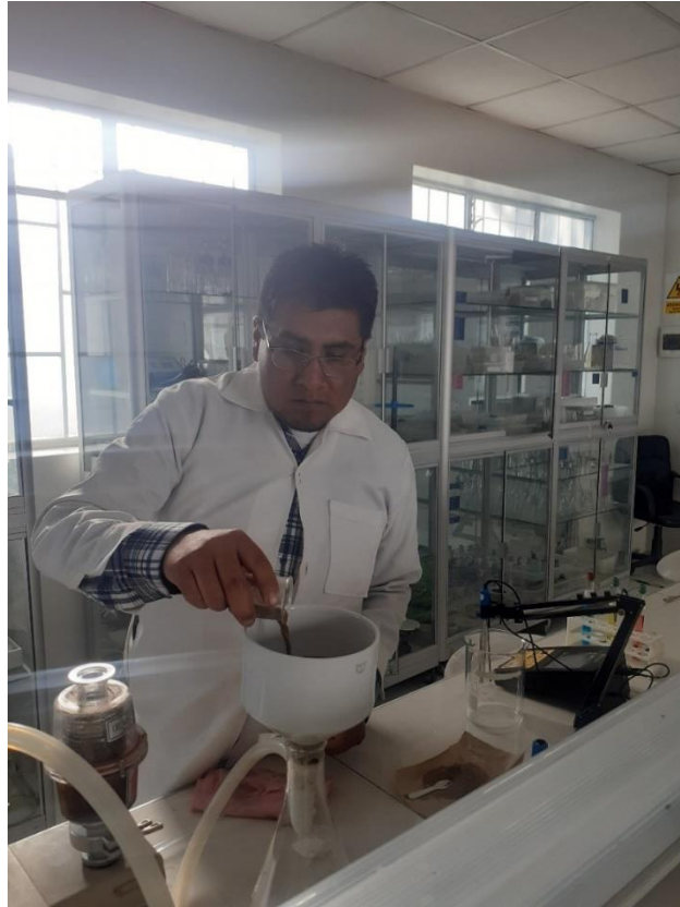
Figura 33 Colocación de muestra en la bomba de vacío
