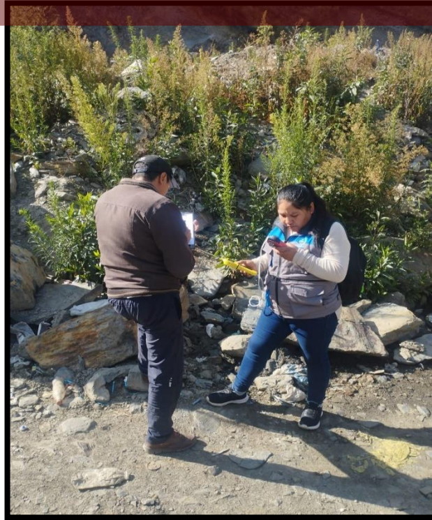
Nota: En la fotografía se aprecia la toma el monitoreo de la concentración de metano en el botadero Ccapuna - Punto 4
