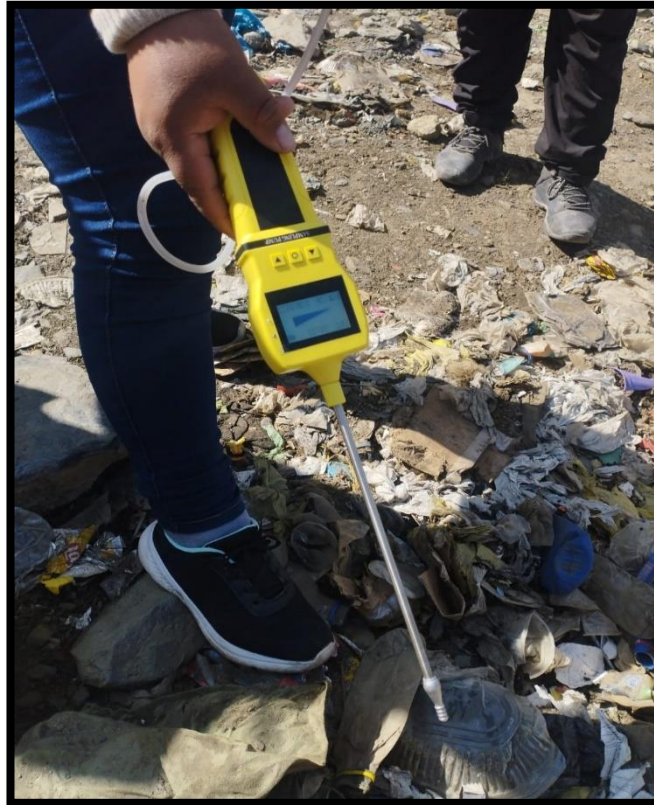
Nota: En la fotografía se aprecia la toma el monitoreo de la concentración de metano en el botadero Ccapuna - Punto 1
