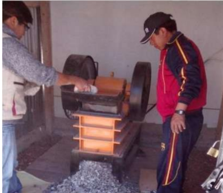
Figura Triturado de los residuos de construcción.
