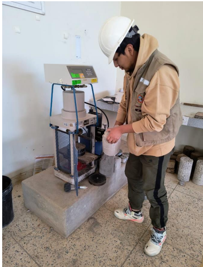
Fotografía 04. Colocación de la primera briqueta después de 24 horas
