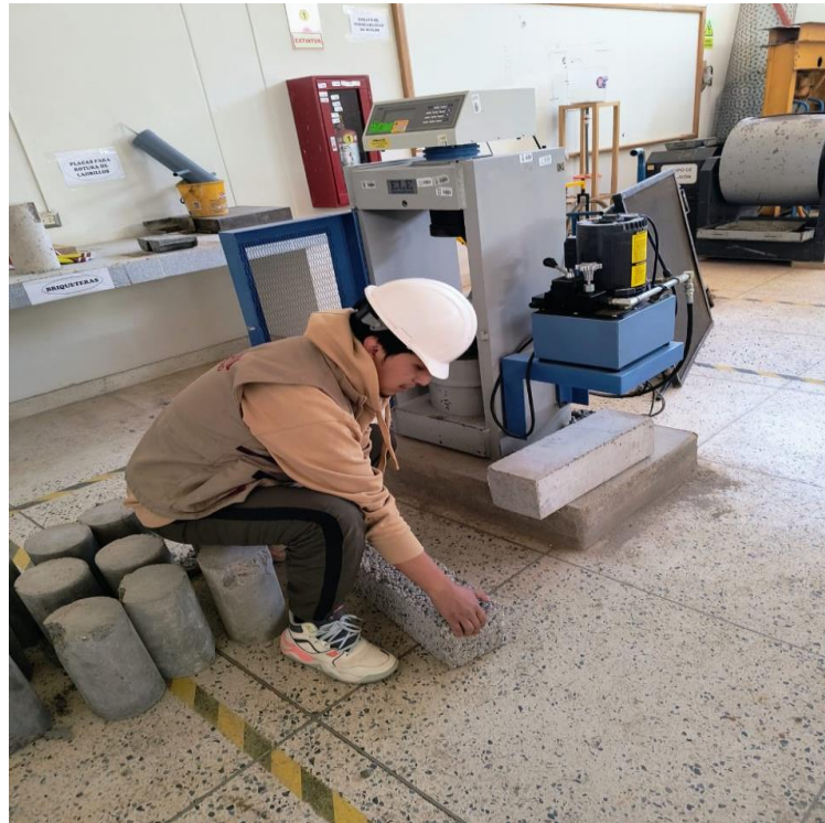
Fotografía 05. Colocación de las viguetas (resistencia a la flexión)
