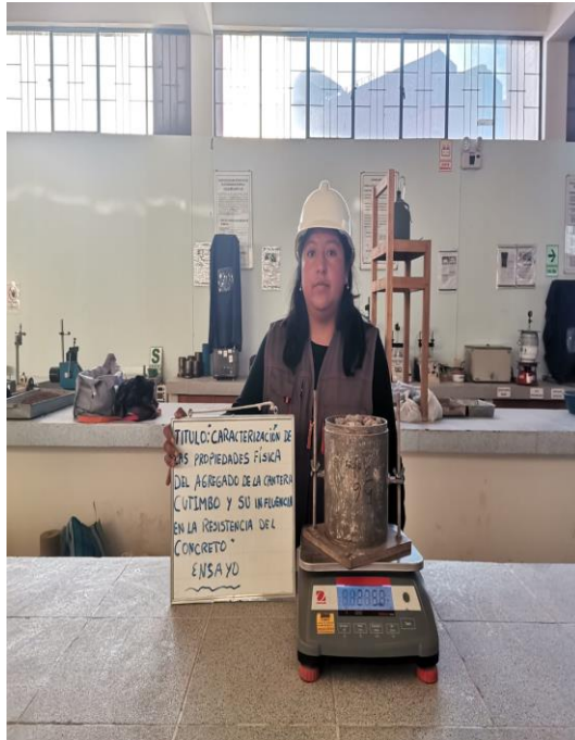
Ensayo de peso unitario
