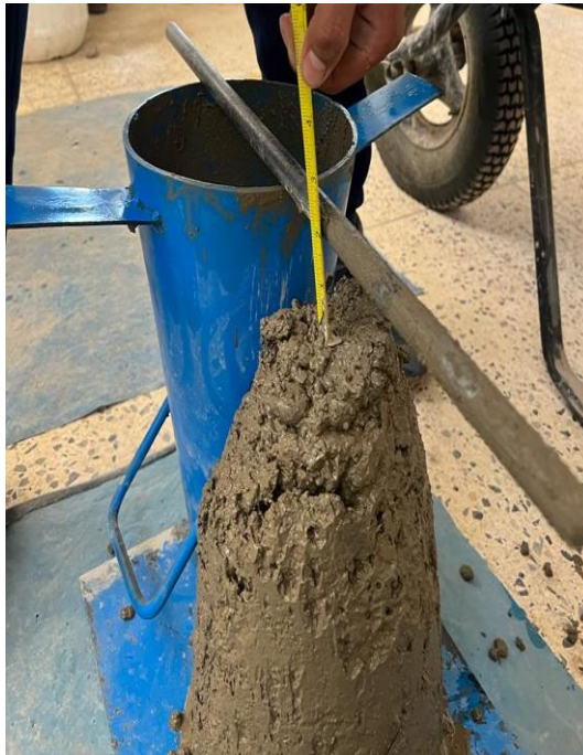
Medimos el slump de nuestro concreto
