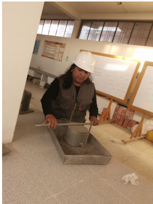
Ensayo de peso unitario de la arena
