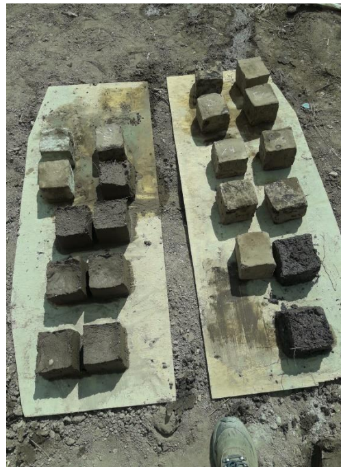
SECADO DE CUBOS DE ADOBE CON RC-250
