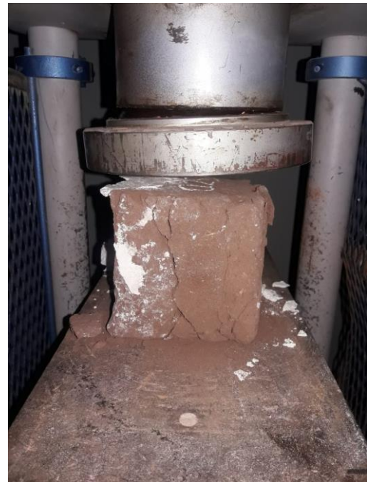
ROTURA A COMPRESIÓN DEL ADOBE
