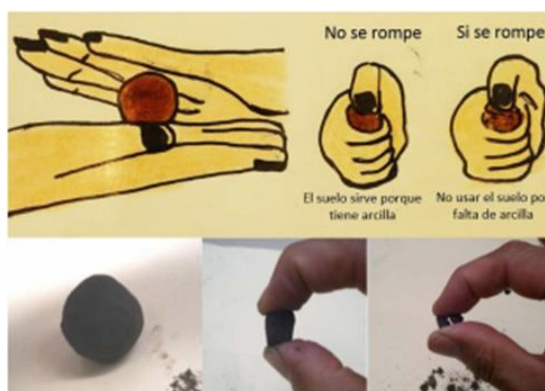
Prueba de la Resistencia Seca de la Bola
