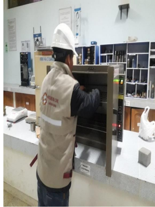
SECADO AL HORNO 105° C
