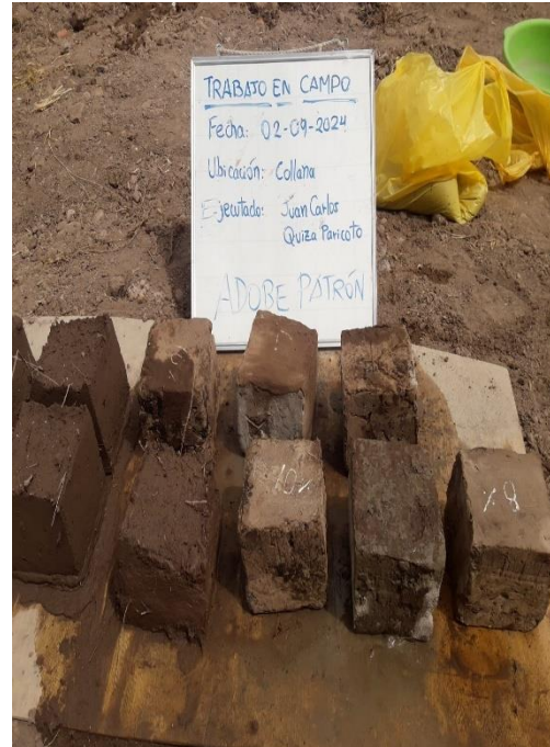
SECADO DE ADOBE MUESTRA PATRÓN
