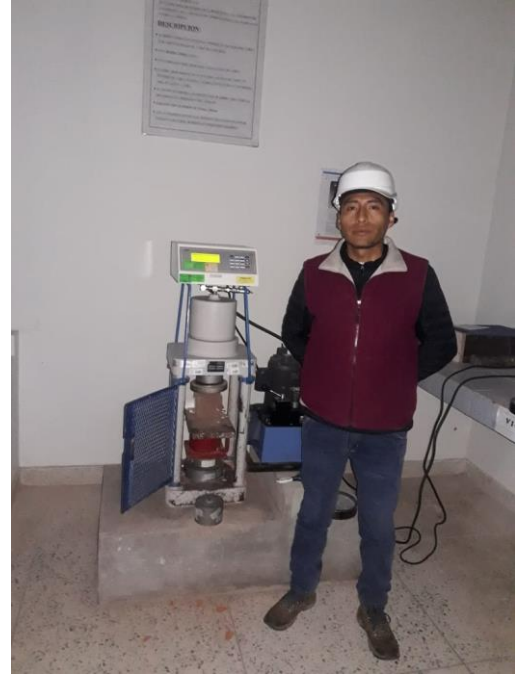
ROTURA A COMPRESIÓN DEL ADOBE
