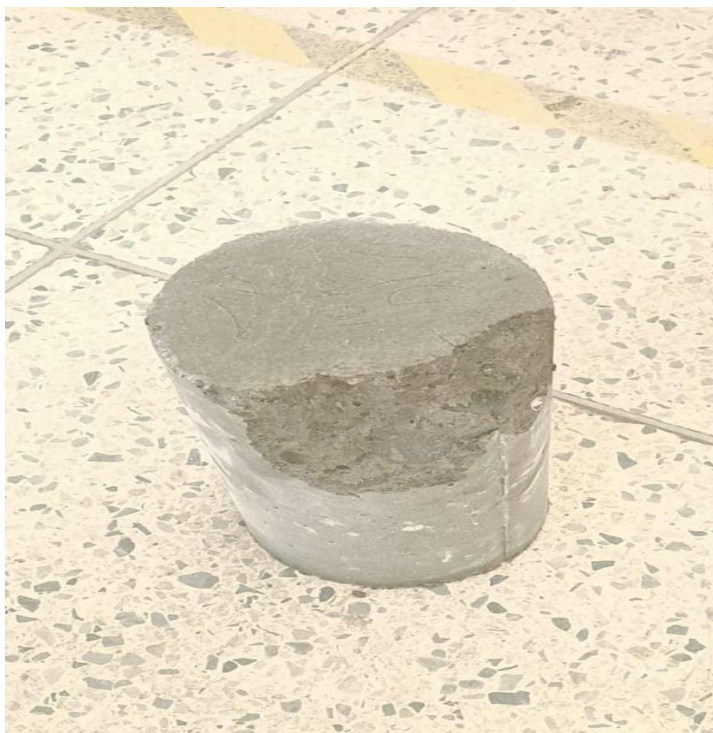
Fotografía 08: Fallo de la briqueta ante la aplicación de cargas.
