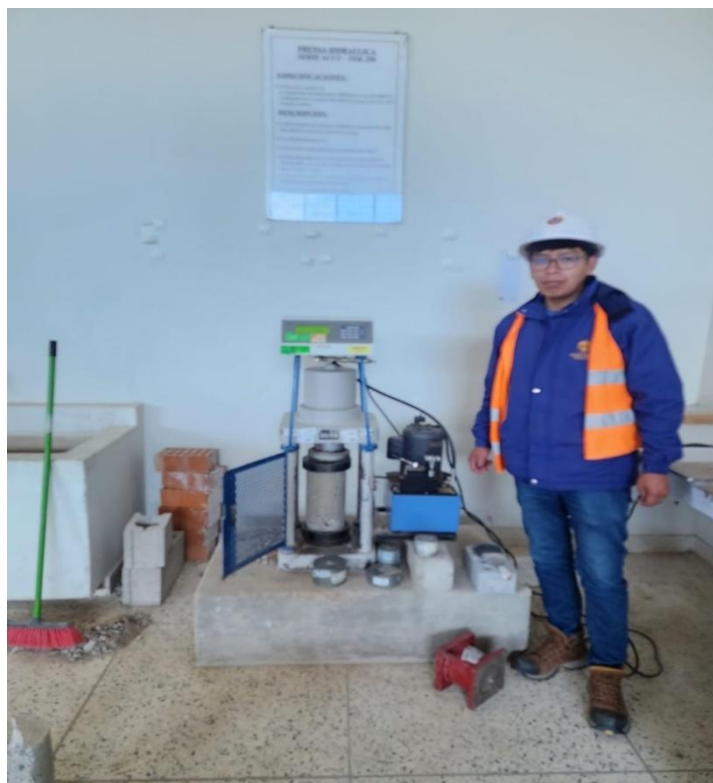
Fotografía 07: Ensayo de compresión en probetas.
