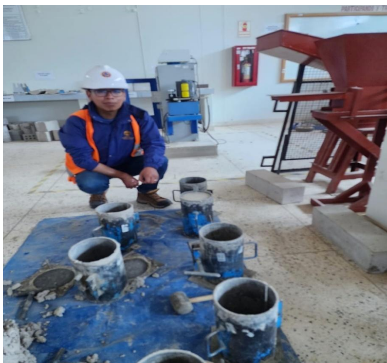
Fotografía 04: Muestras de concreto en el molde
