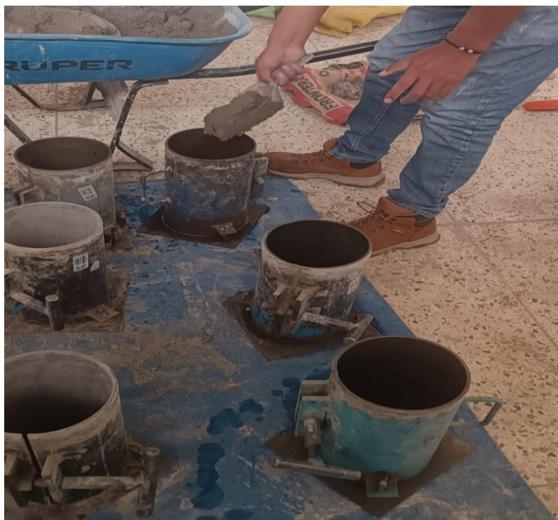
Fotografía 05: Llenado del concreto fresco en el molde.
