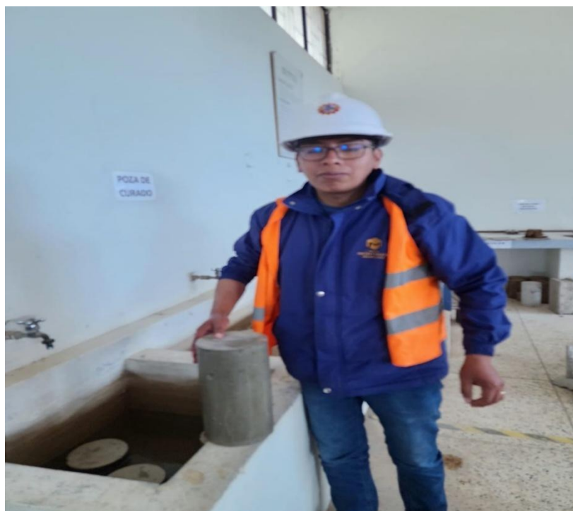
Fotografía 06: Curado de las briquetas
