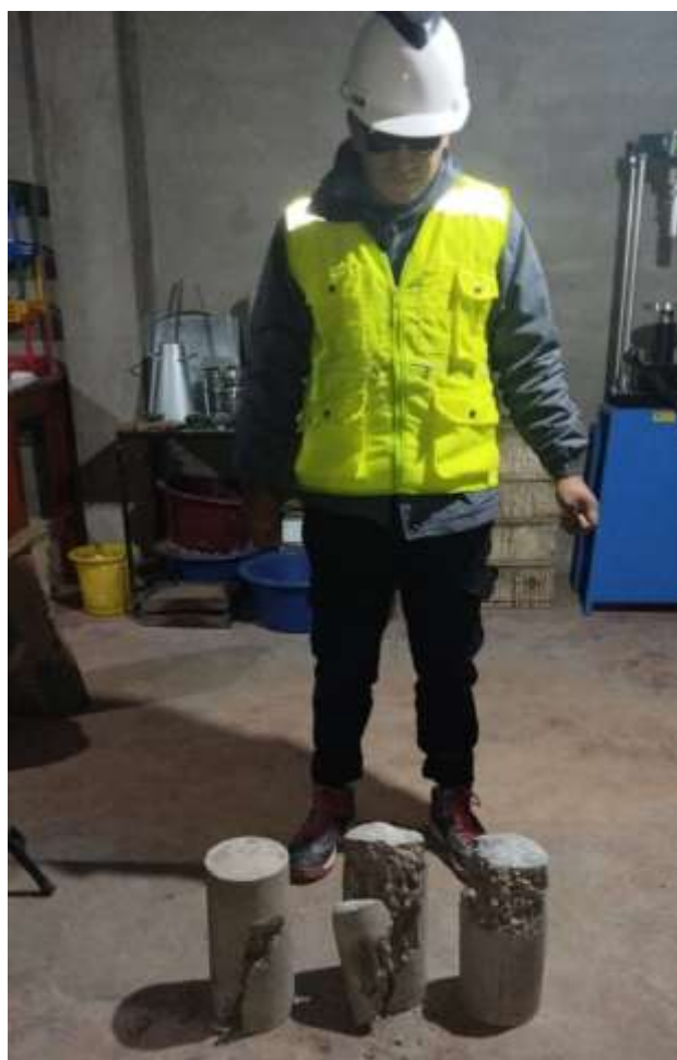
Fotografía 6. Roturas de briqueta
