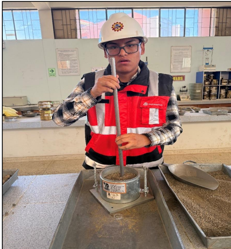
Fotografía N° 15: Varillado de muestra para peso unitario
