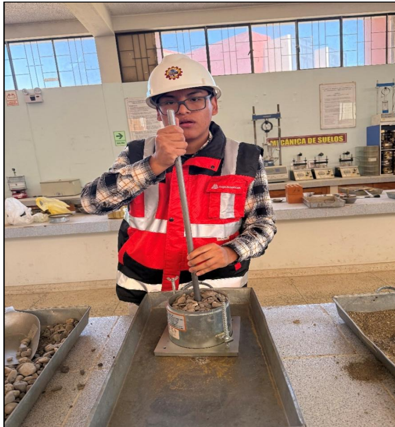
Fotografía N° 19: Varillado de muestra para peso unitario
