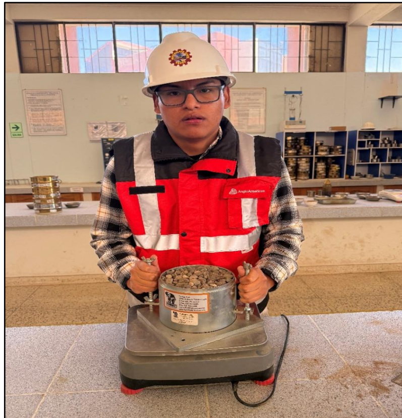
Fotografía N° 21: Pesado del molde + muestra en prueba de pesos unitarios
