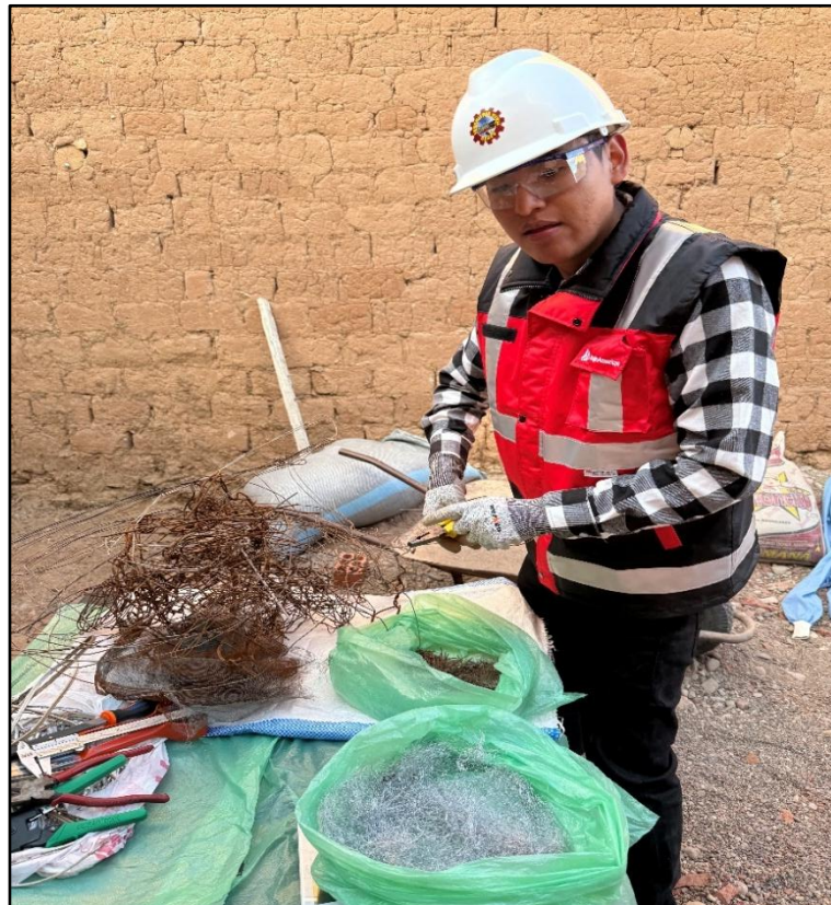
Fotografía N° 04: Cotado del alambre reciclado en pequeñas fibras metálicas
