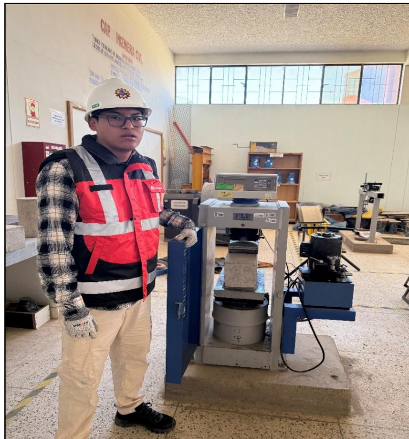
Fotografía N° 30: Rotura de viguetas
