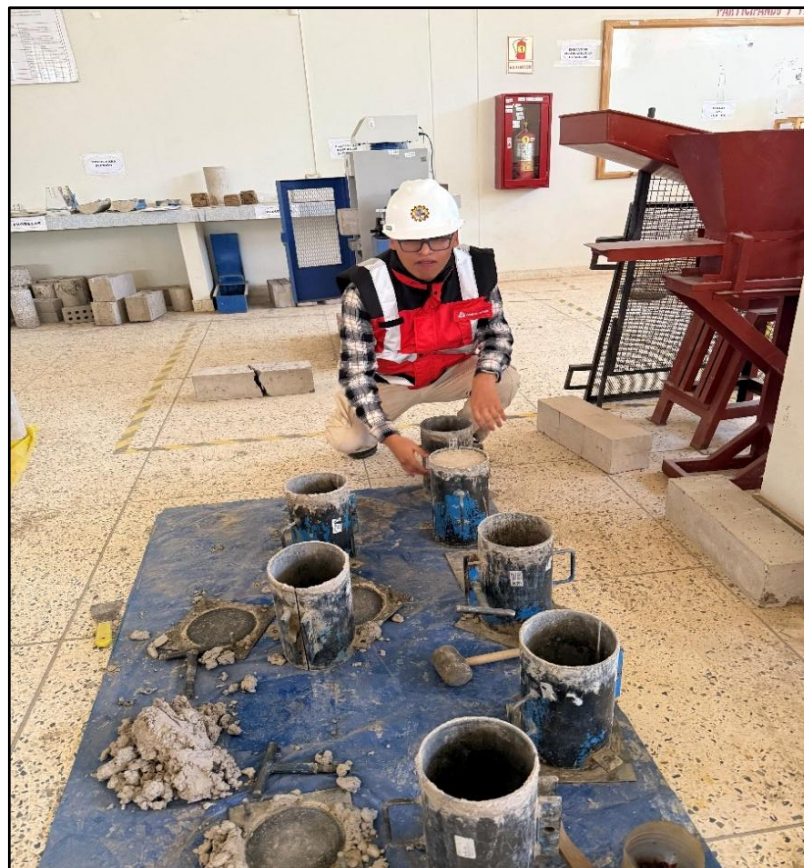
Fotografía N° 22: Desmoldado de briquetas
