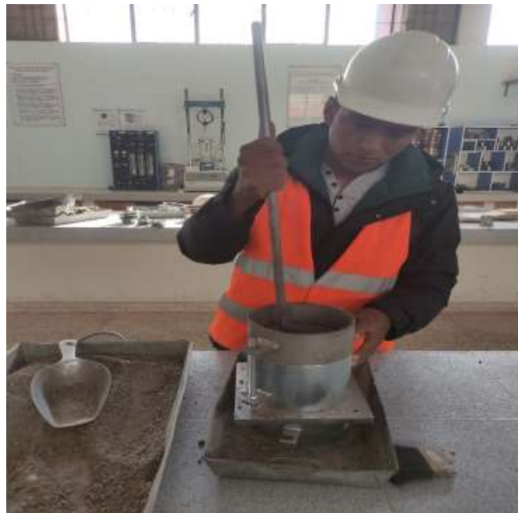
Fotografía 04. Compactación de agregados
