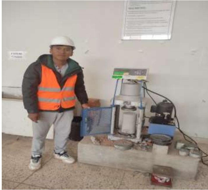
Fotografía 05. Resistencia a compresión de los testigos
