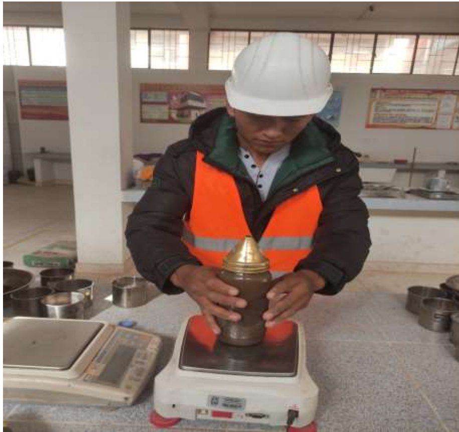
Fotografía 07. Ensayo de contenido de humedad
