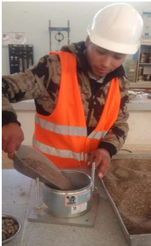
Fotografía N° 08: Llenado de la muestra seca para peso unitario
