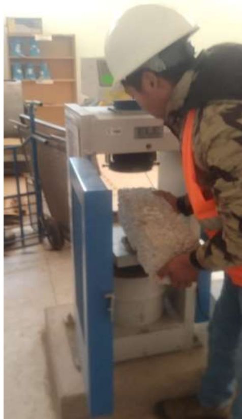
Fotografía N° 16: Ensayo de resistencia a flexión
