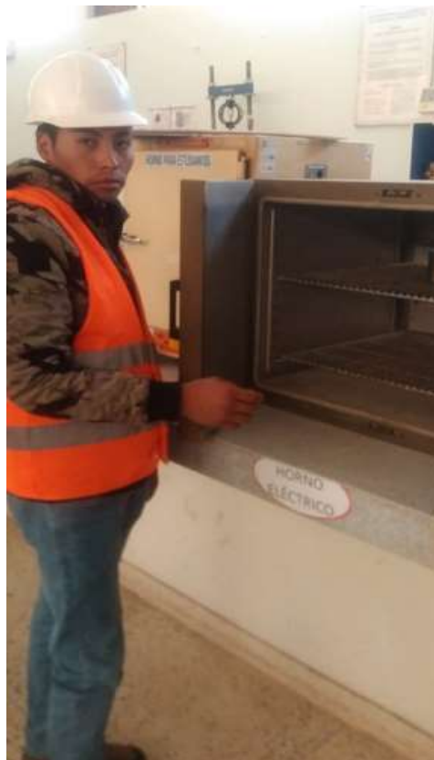
Fotografía N° 04: Secado de la muestra
