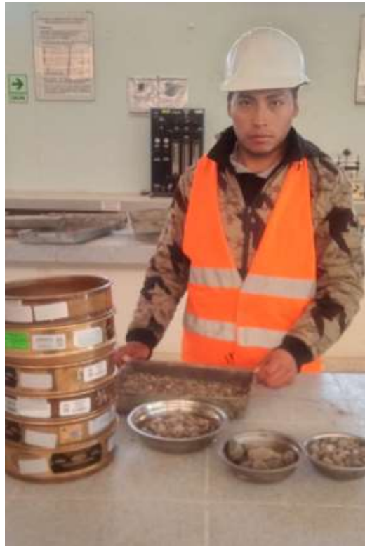
Fotografía N° 01: Ensayo de análisis granulométrico
