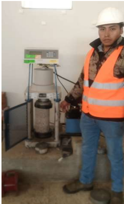
Fotografía N° 14: Ensayo de resistencia a la compresión
