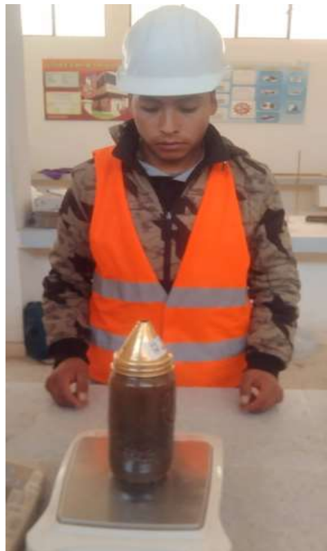
Fotografía N° 06: Pesado del Picnómetro
