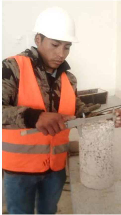
Fotografía N° 13: Medición del diámetro de la briqueta con vernier
