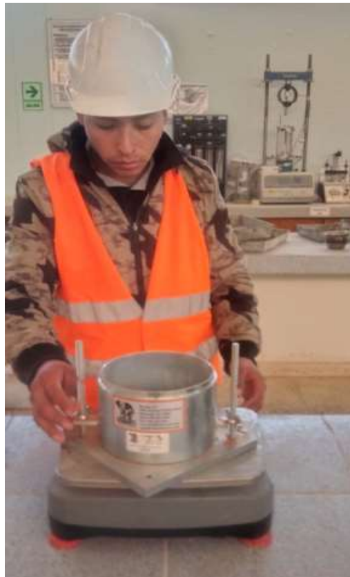
Fotografía N° 07: Pesado del molde para peso unitario
