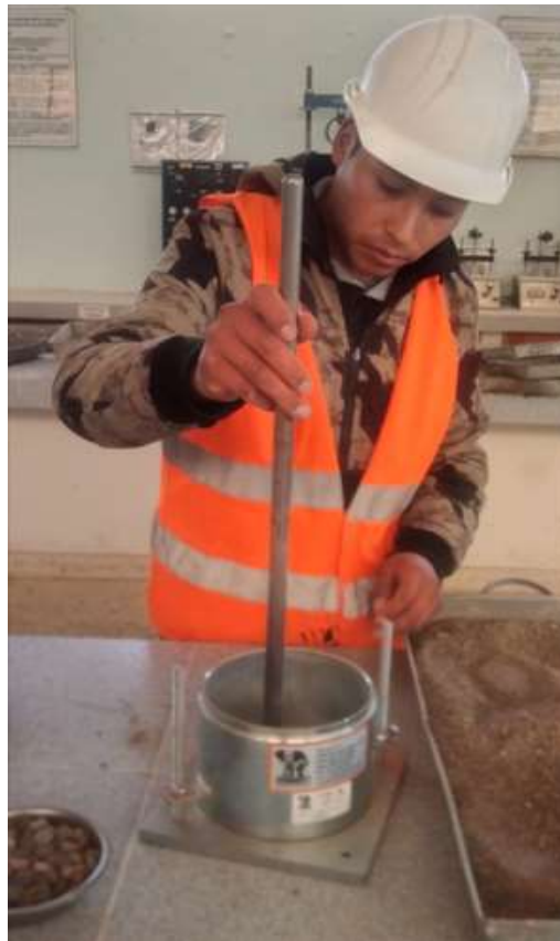
Fotografía N° 10: Resistencia a compresión
