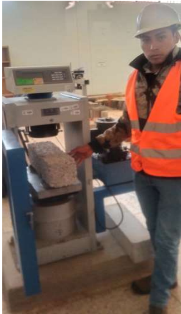
Fotografía N° 17: Rotura de la viga
