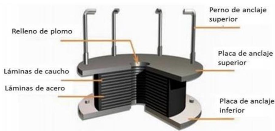
Aislador Elastomérico con Núcleo de Plomo
