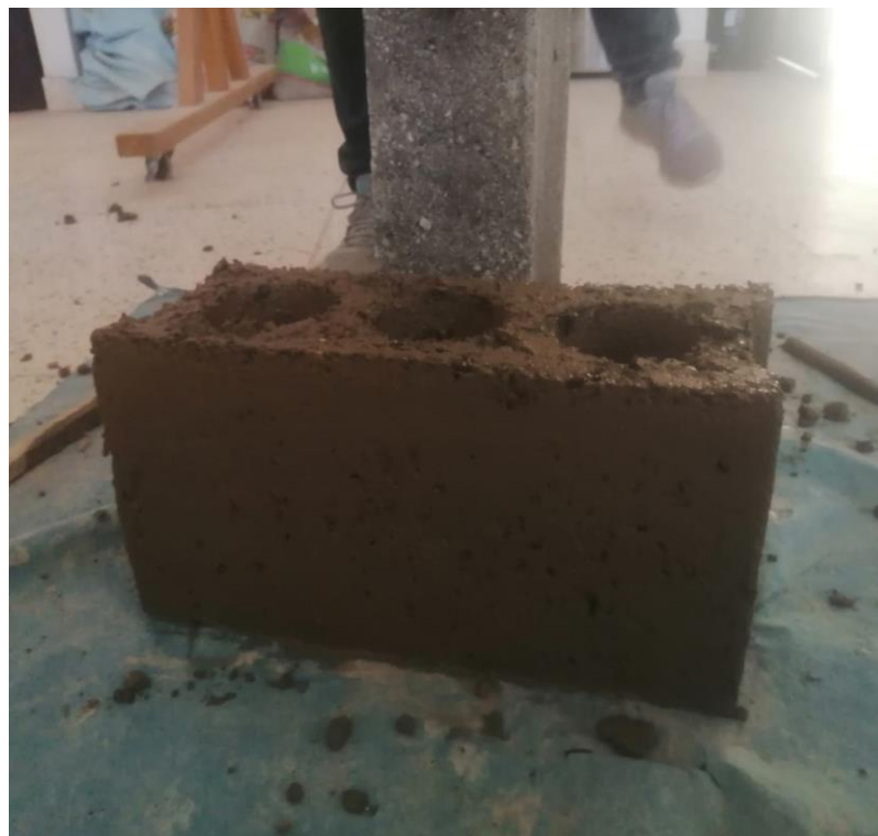
Fotografía 8 Elaboración del bloque de concreto
