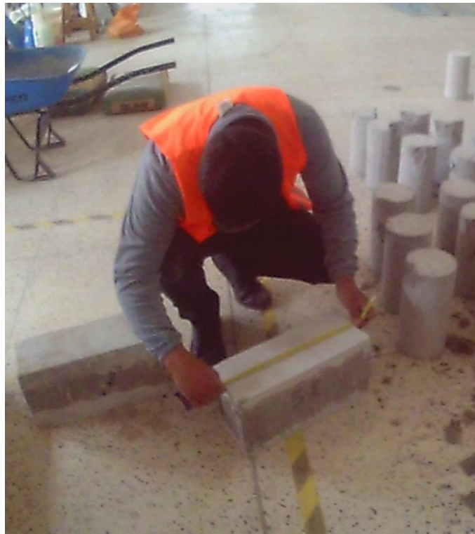
Fotografía 9 Toma de medidas del bloque
