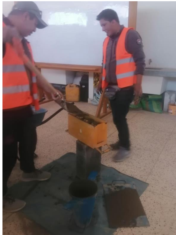
Fotografía 7 Vaciado de bloques de concreto
