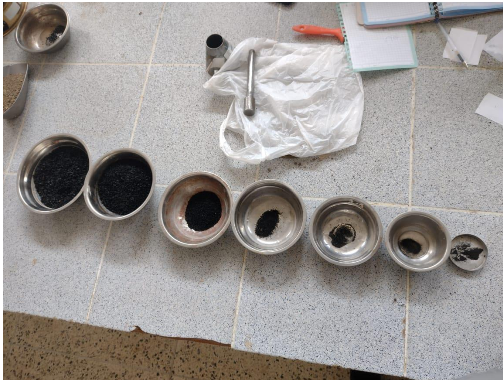
Fotografía 6 Dosificación del caucho neumático
