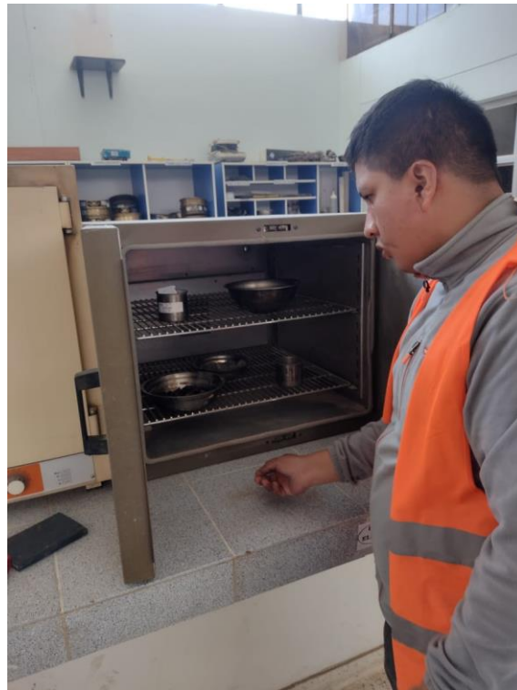
Fotografía 3 Contenido de humedad
