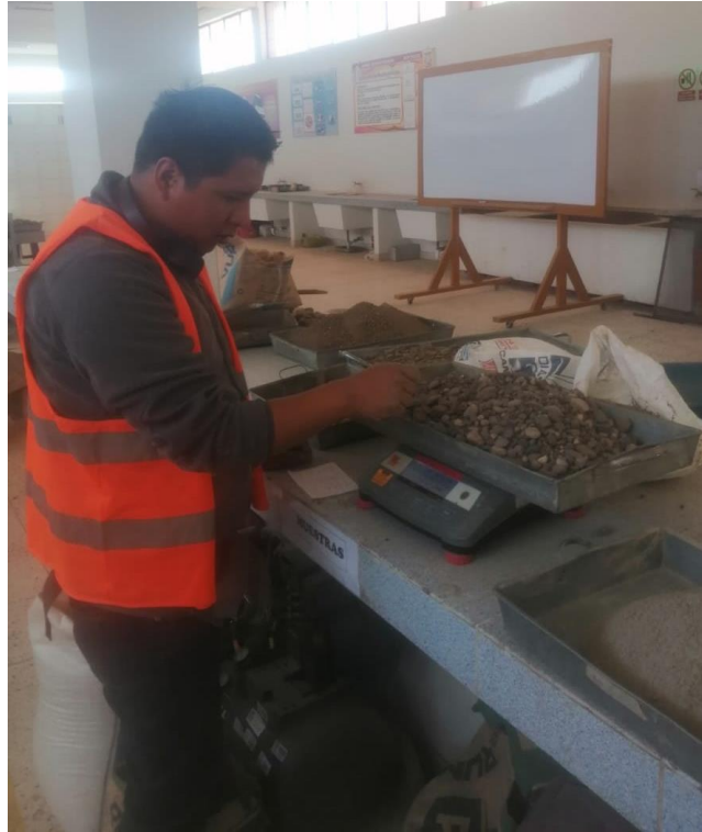
Fotografía 1 Pesado de agregado grueso
