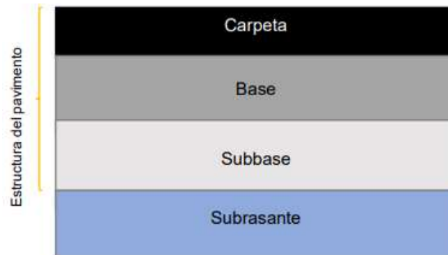
Componentes del pavimento
