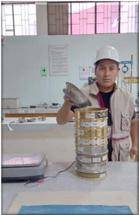
Fotografía N° 03: Tamizado de los agregados
