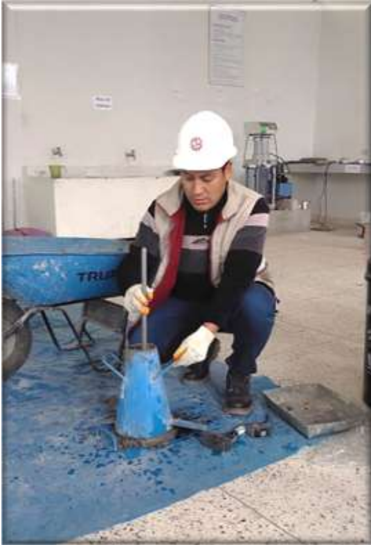
Fotografía N° 08: Prueba de asentamiento (Slump)
