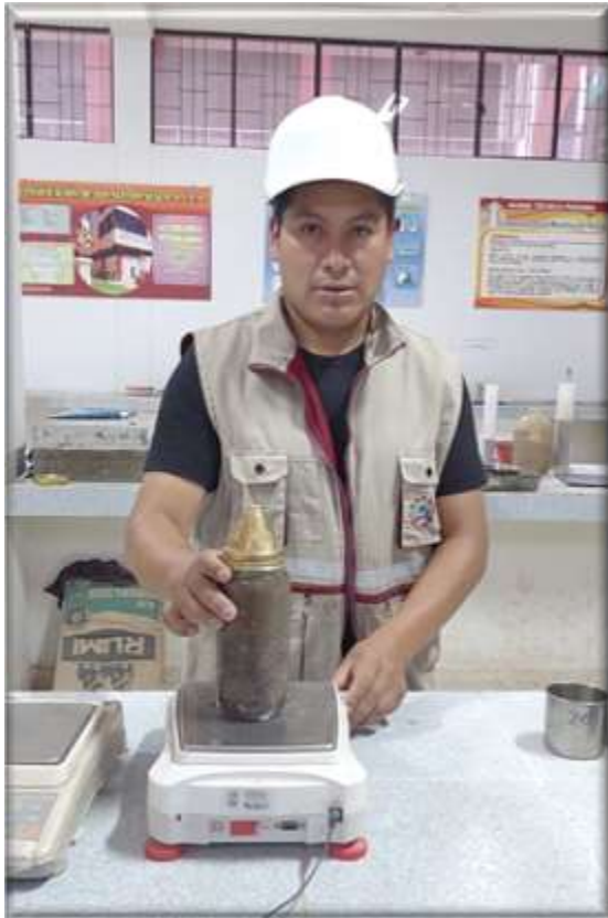
Fotografía N° 06: Ensayo de picnómetro
