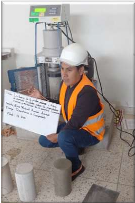
Fotografía N° 11: Roturas de briquetas
