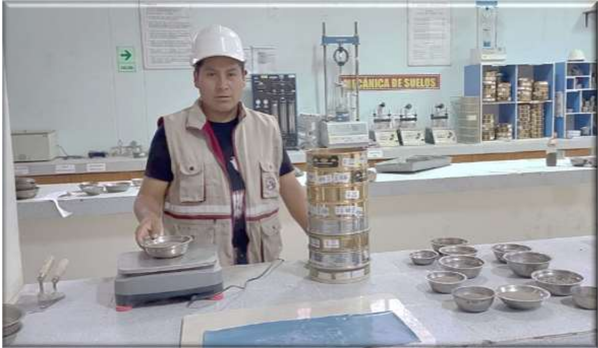
Fotografía N° 02: Pesado de los agregados
