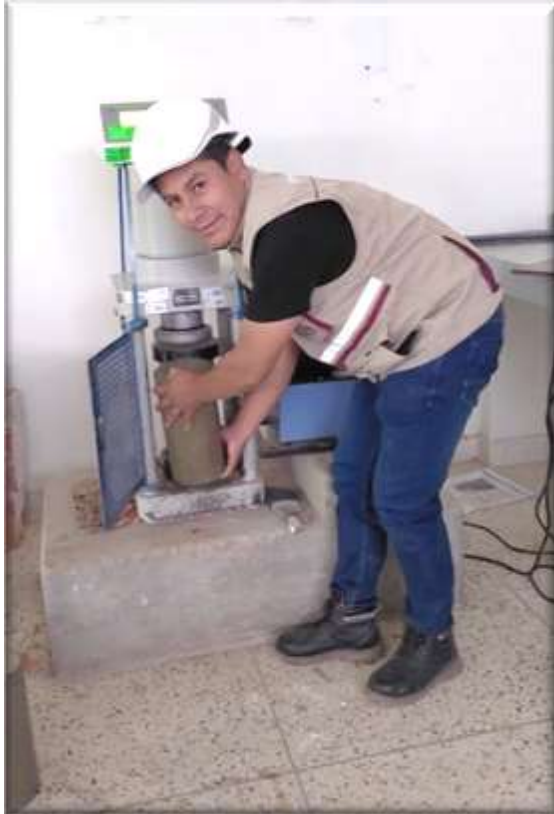
Fotografía N° 10: Resistencia a la compresión
