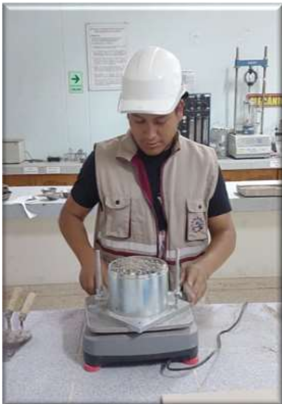
Fotografía N° 04: Ensayo de pesos unitarios
