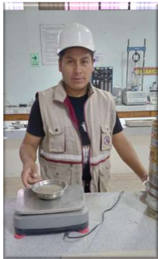
Fotografía N° 03: Pesado de la muestra tamizada
