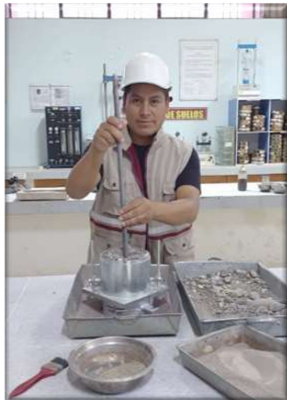
Fotografía N° 04: Ensayo de pesos unitarios
