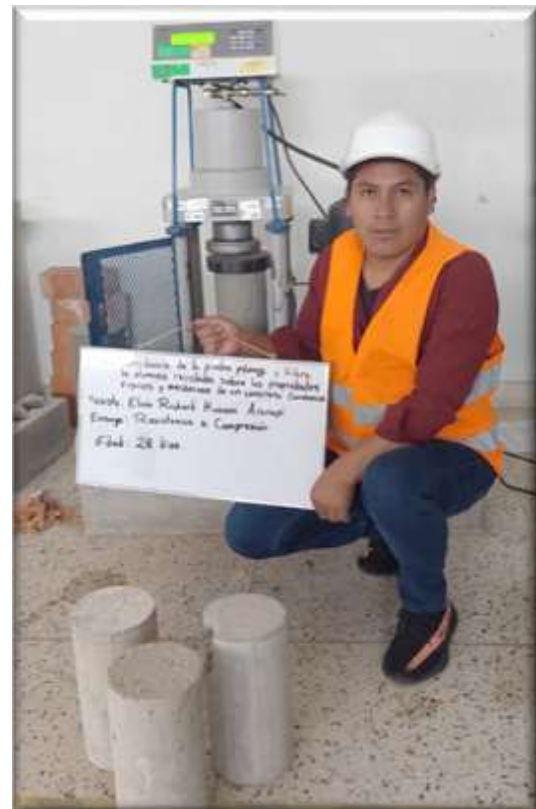
Fotografía N° 11: Roturas de briquetas
