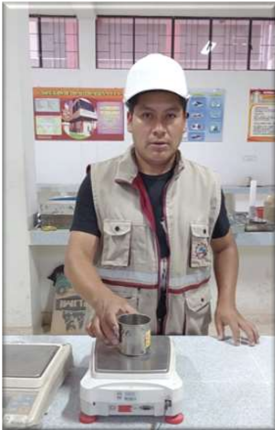
Fotografía N° 05: Pesado y secado de la muestra
