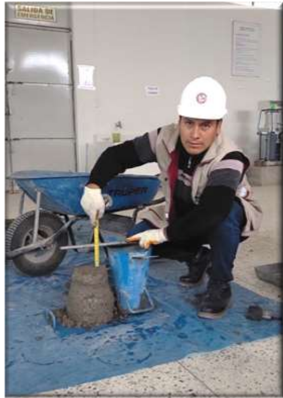
Fotografía N° 08: Prueba de asentamiento (Slump)
