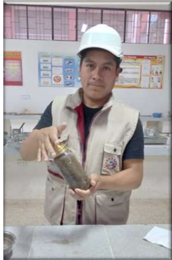
Fotografía N° 06: Ensayo de picnómetro
