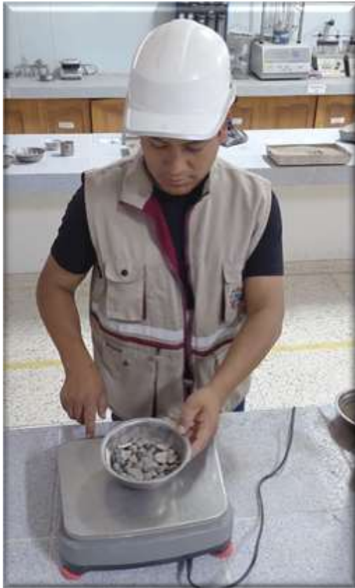
Fotografía N° 03: Pesado de la muestra tamizada
