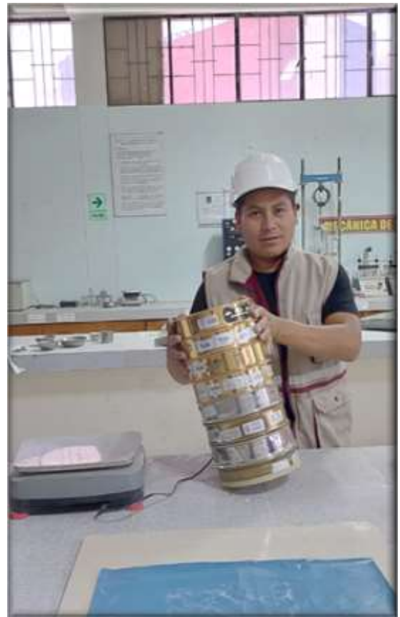
Fotografía N° 03: Tamizado de los agregados
