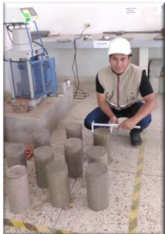
Fotografía N° 09: Medición del diámetro de la briqueta con vernier
