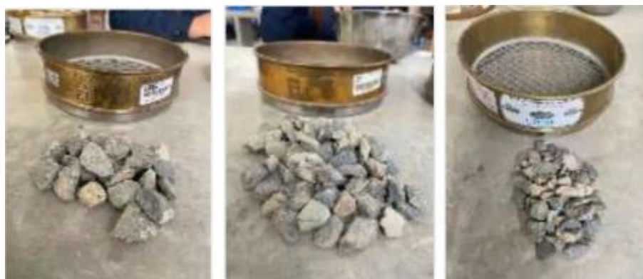
Figura 12. granulometría del agregado grueso
