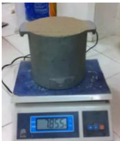
Figura 15. peso unitario del agregado fino
