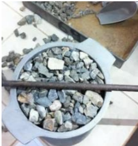
Figura 13. peso unitario del agregado grueso
