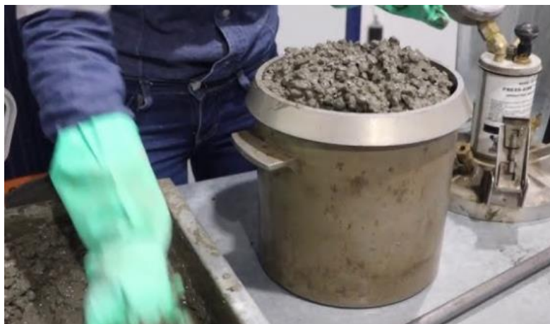
Figura 9. peso unitario del concreto
