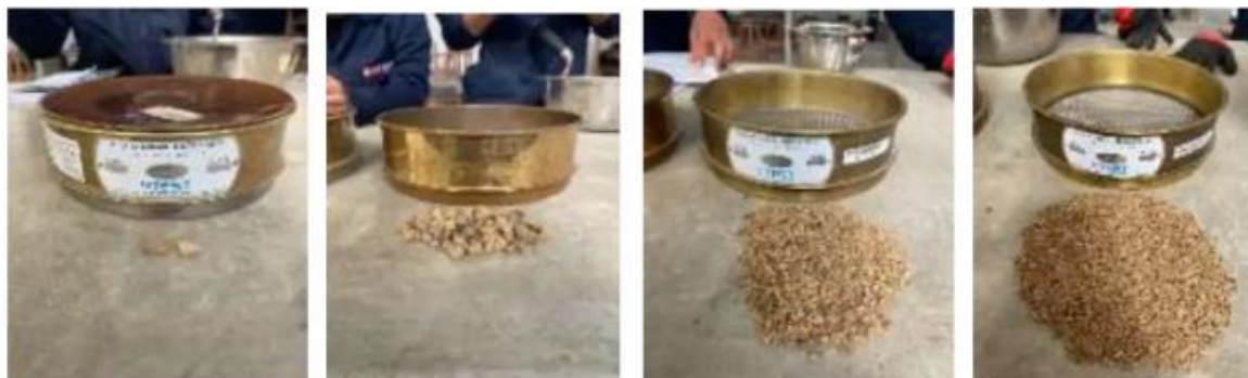
Figura 14. granulometría del agregado fino
