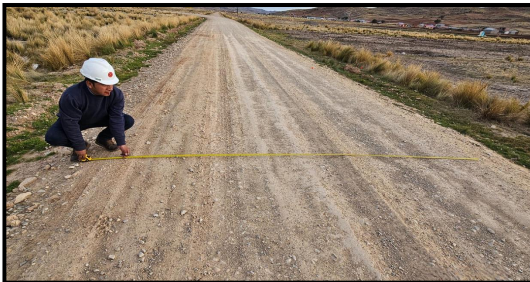
Fotografía 11. Toma de medida del ancho de la calzada
