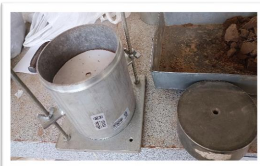
Muestra de suelo compactado
