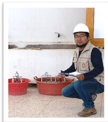
Anotaciones de los deformímetros de las muestras sumergidas
