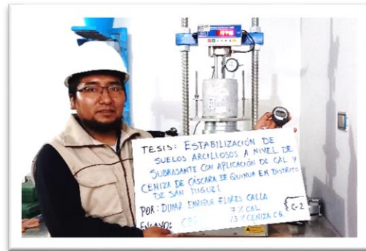
Ensayo penetración CBR
