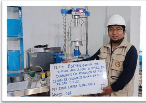
Ensayo de penetración CBR
