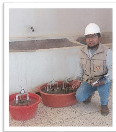
Anotaciones de los deformímetros de las muestras sumergidas
