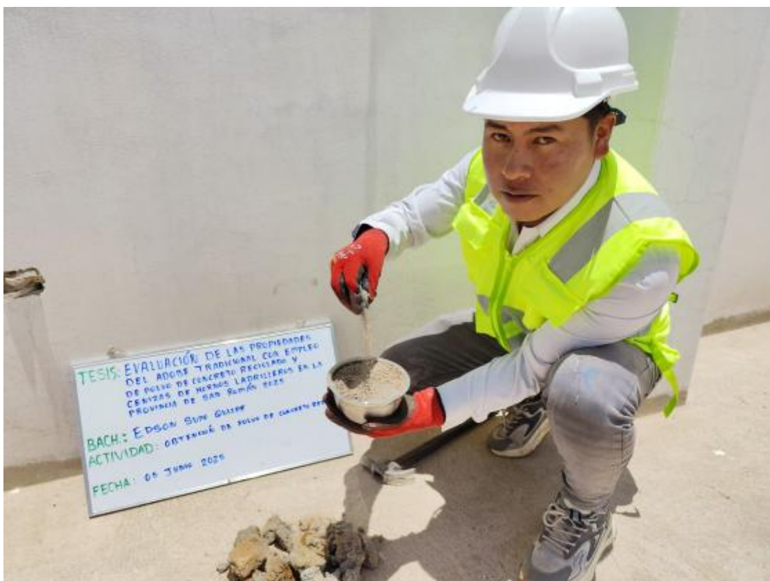
Fotografía N° 03: Obtención de la muestra polvo de concreto reciclado
