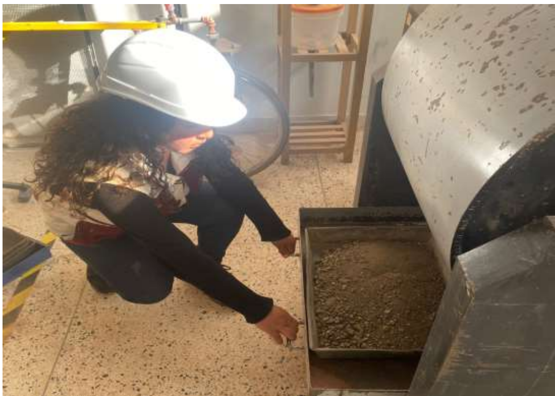
Fotografía 14. Levantamiento de las muestras post ensayo de los Ángeles
