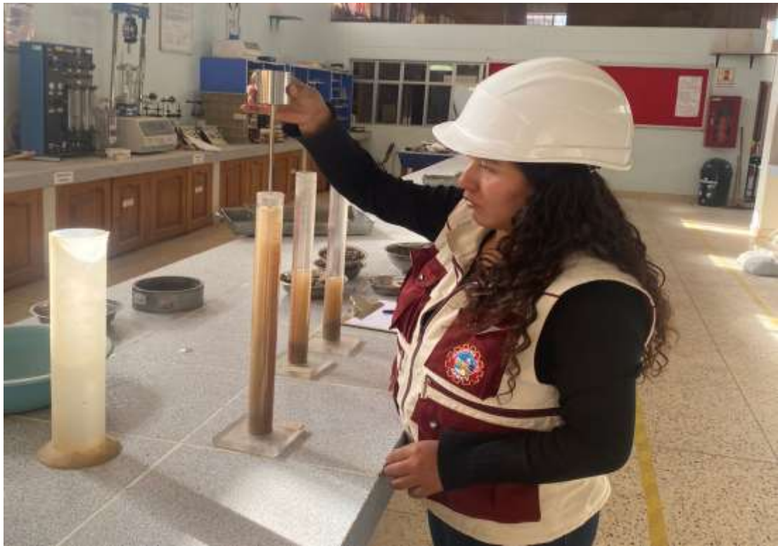
Fotografía 11. Dosificando los materiales para el ensayo de densidad de suelos
