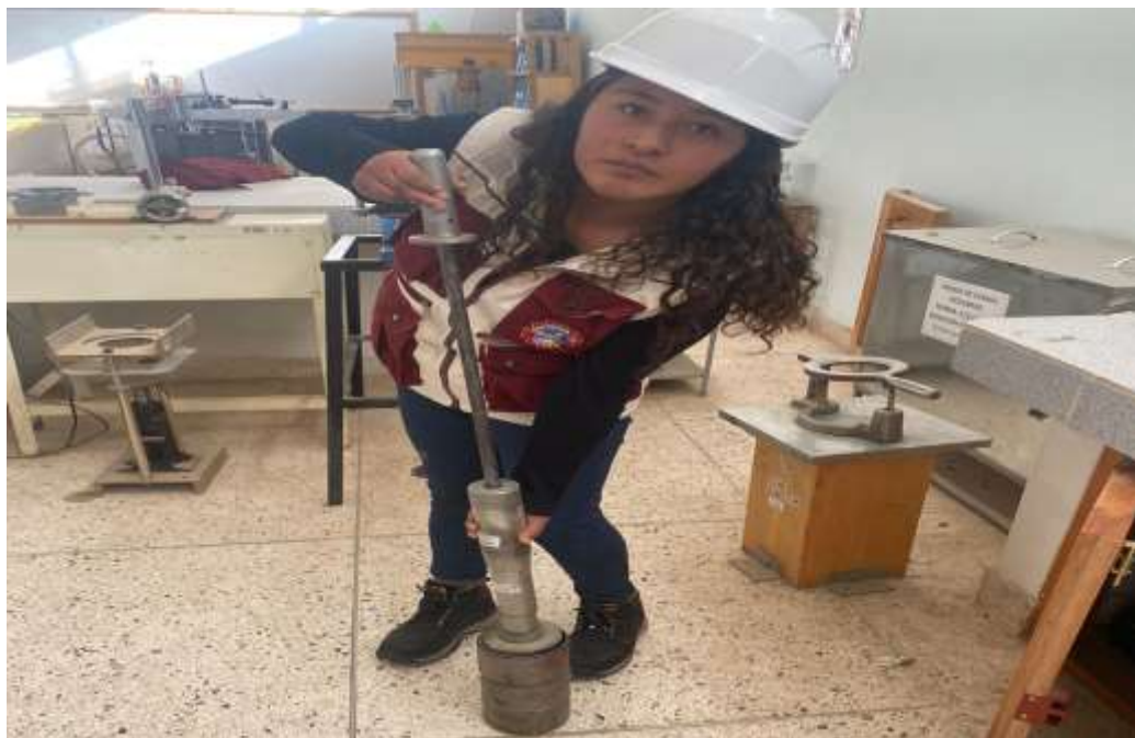
Fotografía 04. Verificación de los materiales para la compactación de suelos
