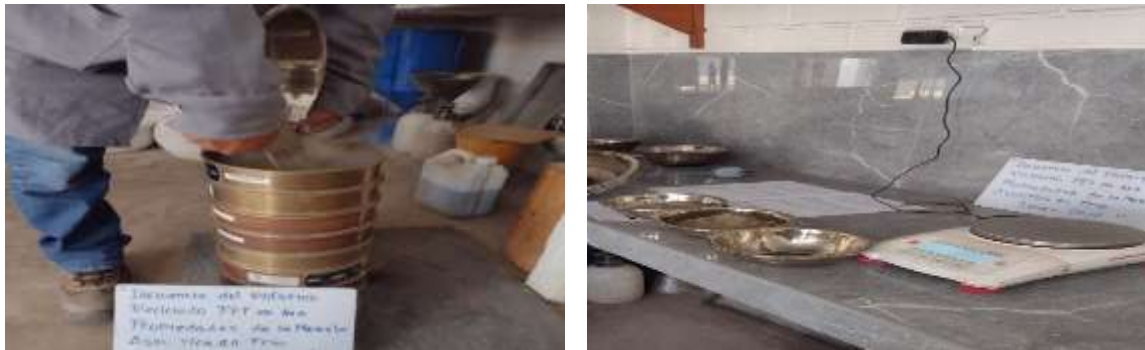
Tamizado de agregados finos
