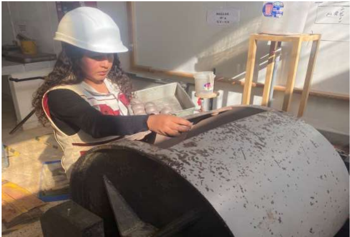
Fotografía 13. Preparación del instrumento para la prueba de los ángeles
