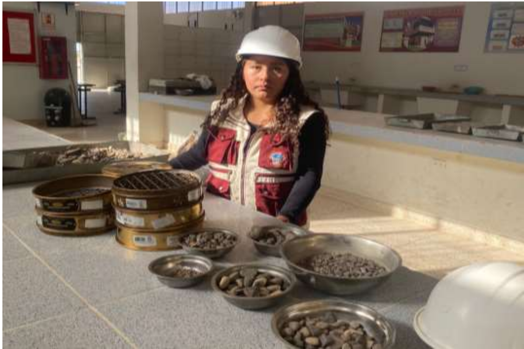
Fotografía 09. Preparación de los agregados para el tamizado
