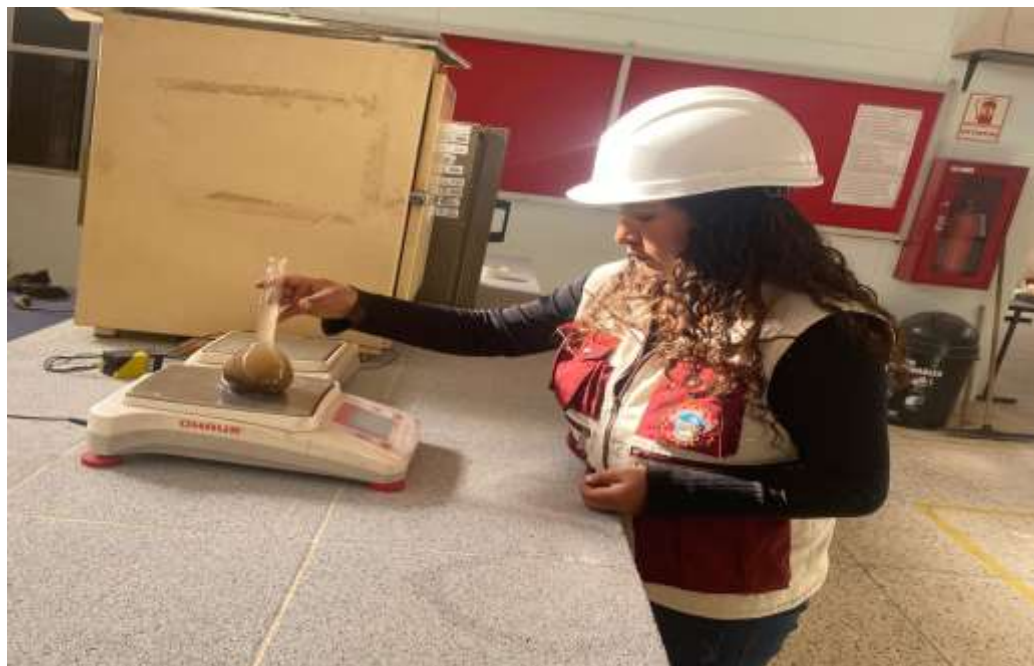
Fotografía 06. Pesaje de las pipetas para el cálculo de humedad
