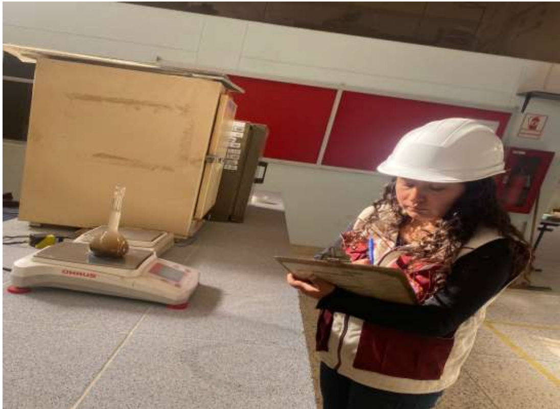
Fotografía 05. Pesaje para los análisis de suelos
