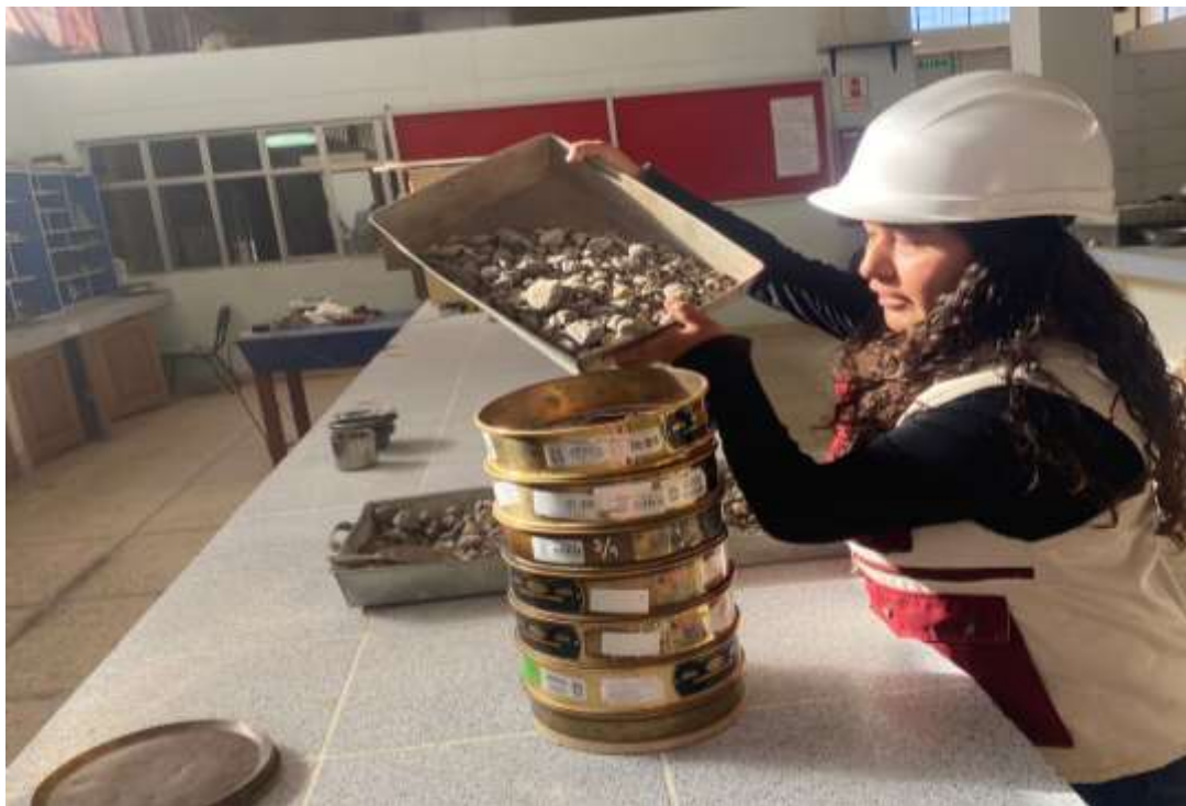
Fotografía 10. Tamizado de las muestras de la avenida Triunfo
