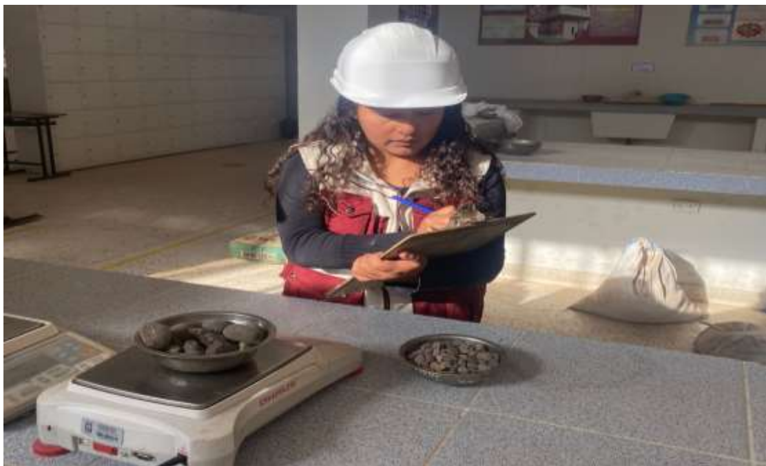
Fotografía 08. Calculo de los pesos y dosificaciones de agregados
