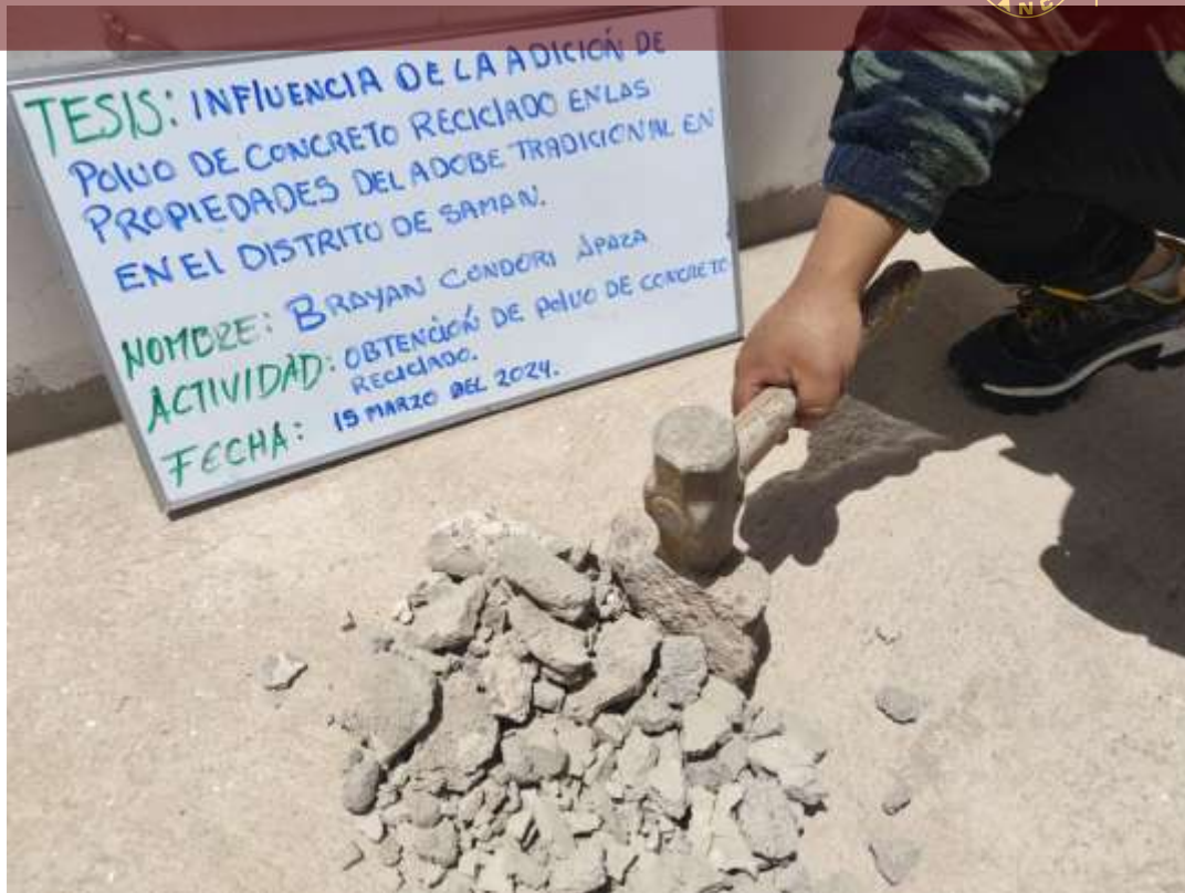
Fotografía 1. Triturado del concreto reciclado
