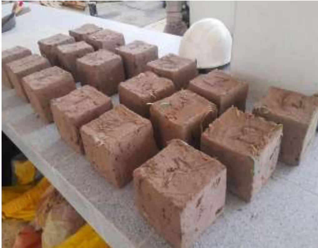
Fotografía 5. Adobes en cubos
