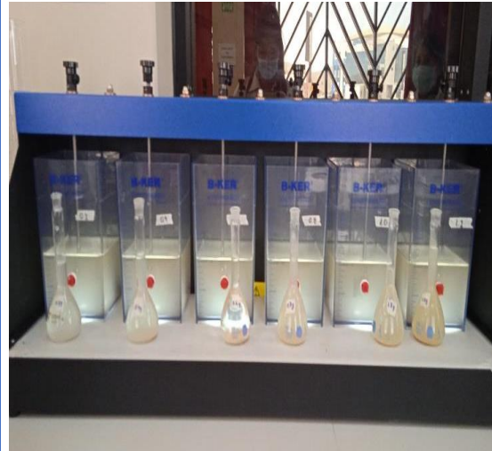
Prueba de jarras con el cuerpo de agua, con las diferentes tipos de dosis.
