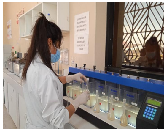
Disolviendo cada una de las dosis en los vasos precipitados de la prueba de jarras.
