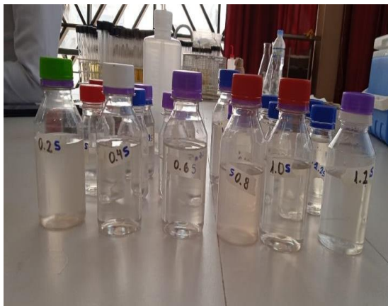
Se puede visualizar que la dosis idónea es de 0.4 ya que esta menos turbia que las demás.
