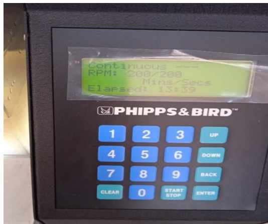
200 rpm programadas en la prueba de jarras, en tiempos diferentes.
