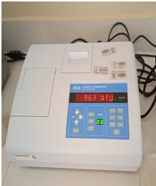
96.3 NTU – Nivel de turbiedad del cuerpo de agua
