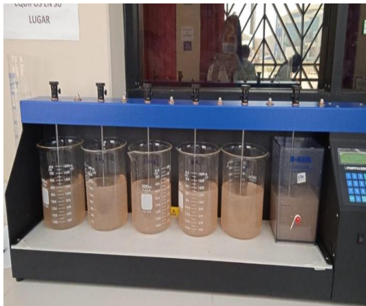
Prueba de jarras en funcionamiento.
