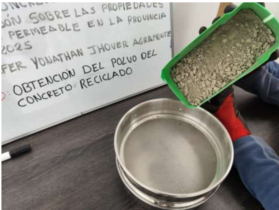
Fotografía 4. Obtención de polvo de concreto reciclado.
