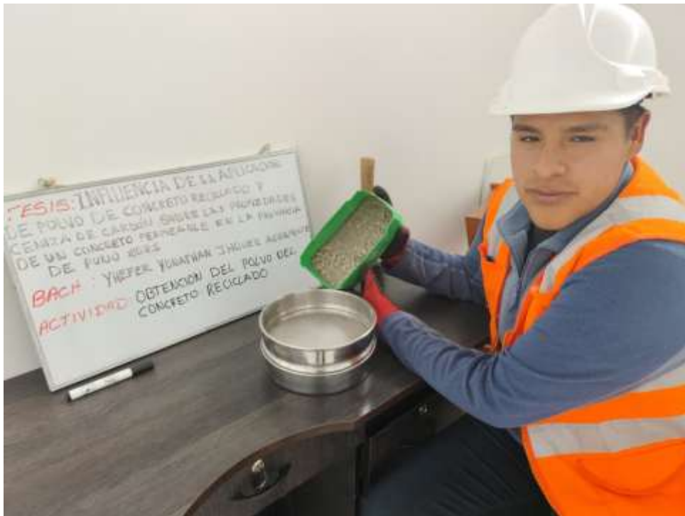
Fotografía 3. Tamizado de concreto reciclado triturado.
