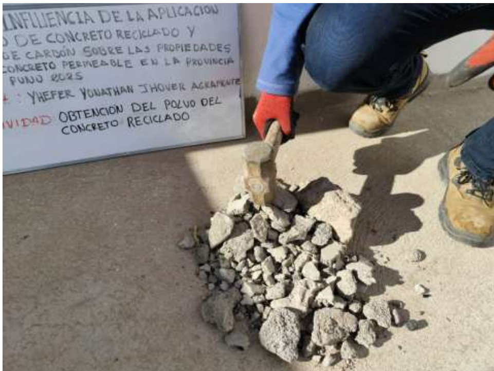
Fotografía 2. Trituración de concreto reciclado.
