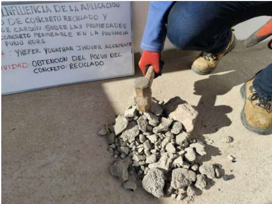
Fotografía 11. Trituración del concreto reciclado
