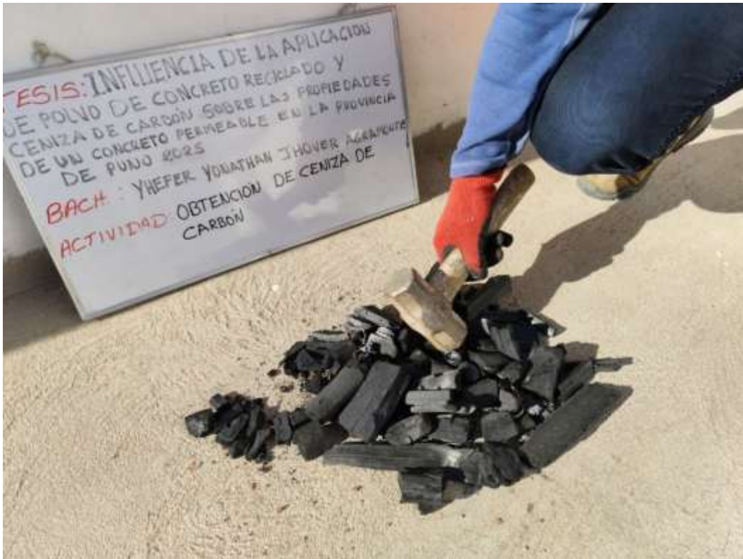
Fotografía 9. Trituración del Carbón
