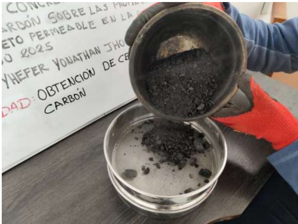
Fotografía 10. Tamizado del carbón
