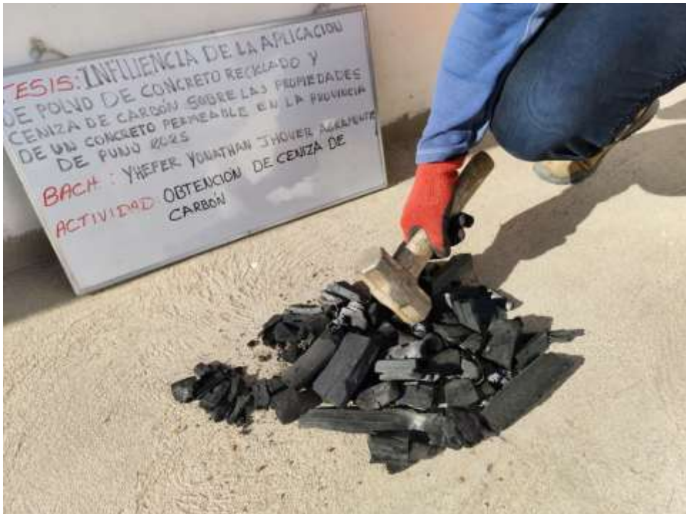
Fotografía 6. Trituración de ceniza de carbón.
