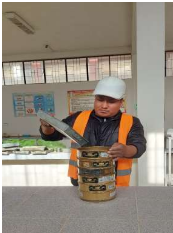
Fotografía 2. Ensayo de granulometría por tamizado
