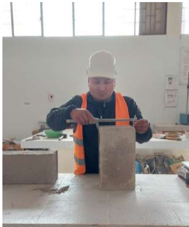
Fotografía 8. Toma de medidas del Bloque de concreto (alto)
