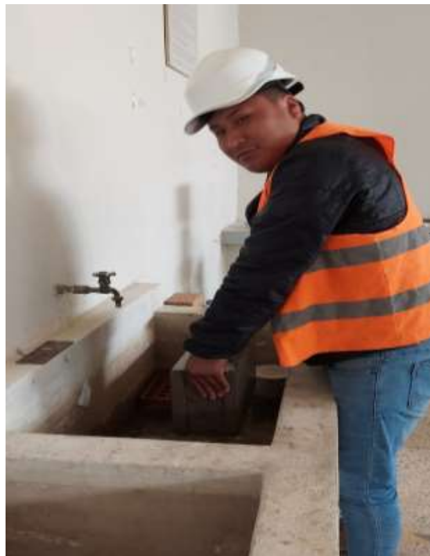
Fotografía 10. Curado del bloque de concreto
