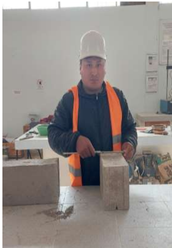
Fotografía 6. Toma de medidas del Bloque de Concreto (Ancho)
