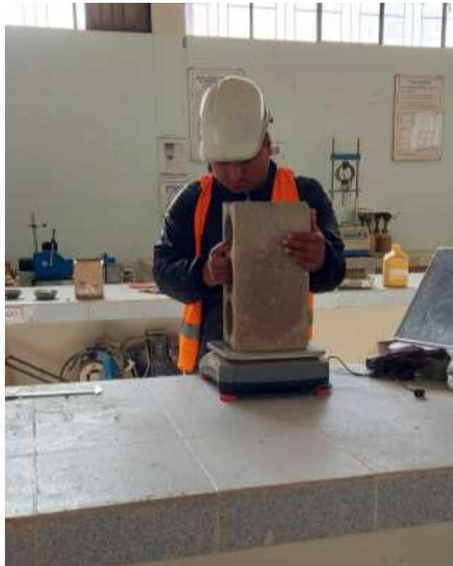
Fotografía 9. Pesado del Bloque de Concreto
