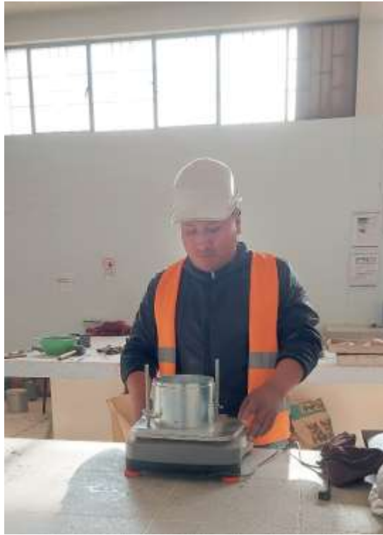
Fotografía 5. Ensayo de Proctor modificado en muestra de suelo natural
