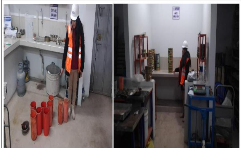
Foto N° 15: preparación de moldes de briquetas.
