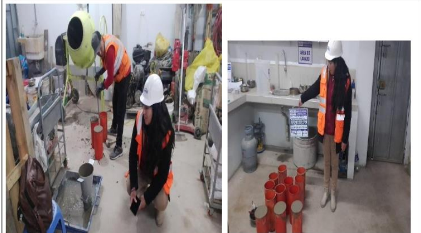
Foto N° 17: Se muestra la elaboración de las briquetas de concreto.
