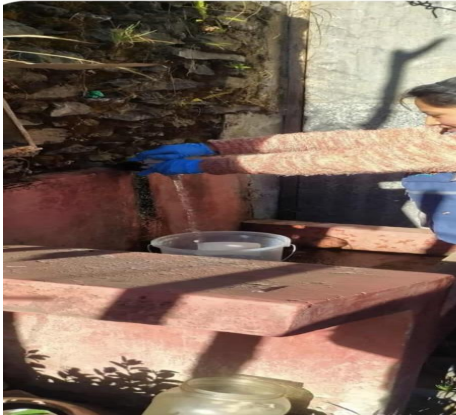
Fotografía 5. Toma de muestras de la red de distribución de agua potable del distrito de Cuyocuyo.
