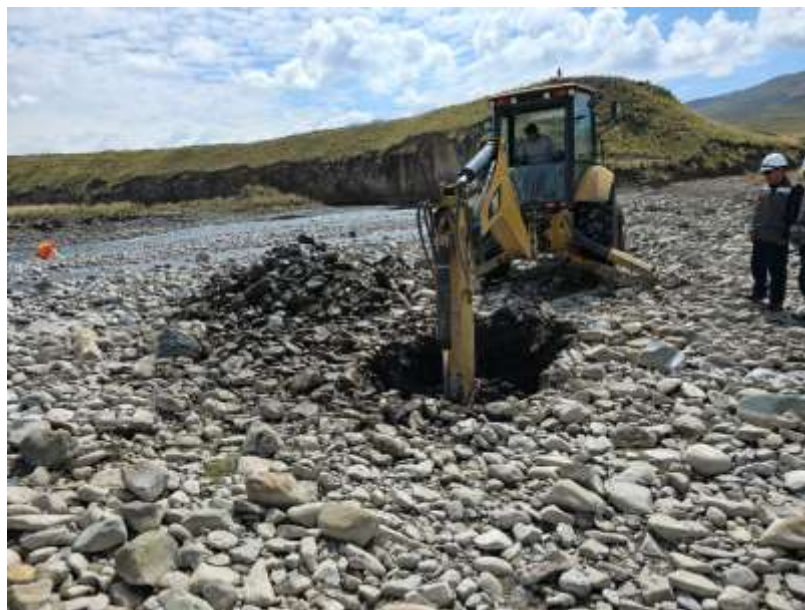
Toma de muestras en calicata exploratoria para estudio de mecánica de suelos.
