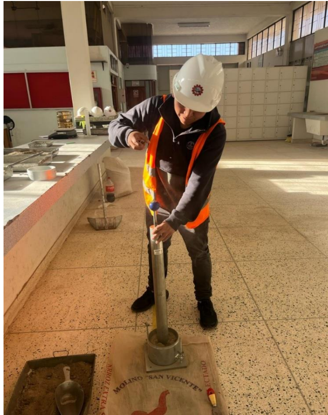
Fotografía 11. Realizando la caída del pisón en el material
