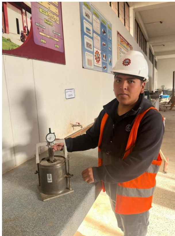
Fotografía 18. Colocación de la muestra en el molde - CBR
