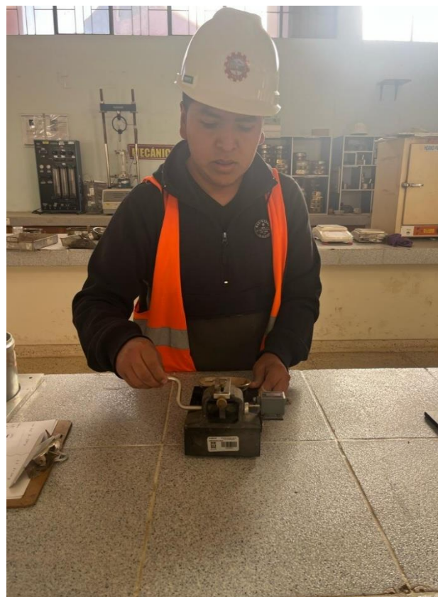
Fotografía 14. Ensayo de la cuchara Casagrande
