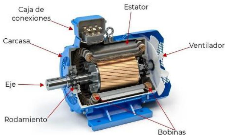
Figura 1. Motor trifásico de jaula de ardilla
