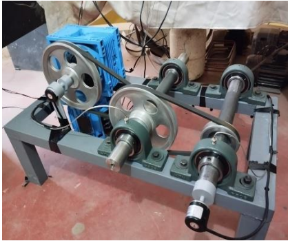
Figura 55 Implementación de transmisión mecánica y montaje de motor reductor.
