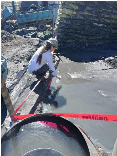
Fotografía 1. Toma de muestras para hallar la concentración de mercurio en las colas de amalgamación de la empresa Inversiones Jhoalicon.
