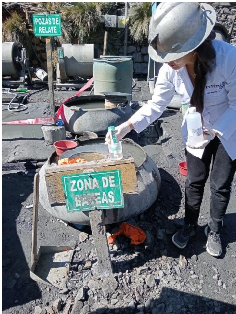
Fotografía 4. Determinación de los parámetros in situ en el agua.
