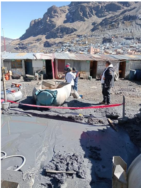
Fotografía 1. Toma de muestras para hallar la concentración de mercurio en las colas de amalgamación de la empresa Inversiones Jhoalicon.
