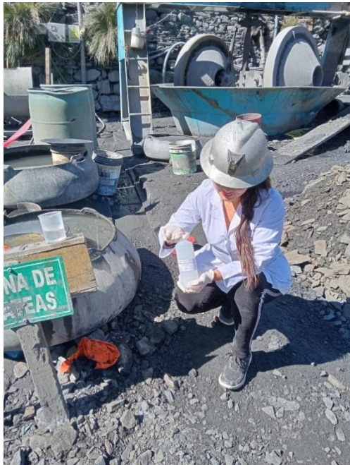
Fotografía 3. Toma de muestras para estimar el contenido del mercurio en el agua.
