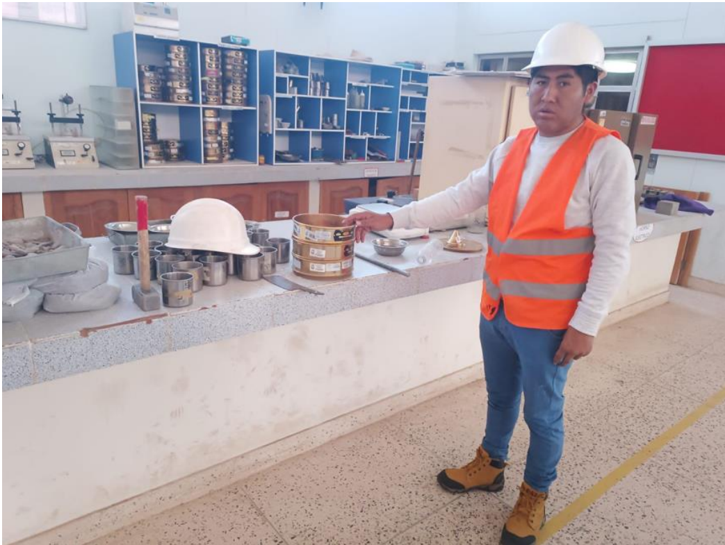
Fotografía N° 01: Ensayo de análisis granulométrico
