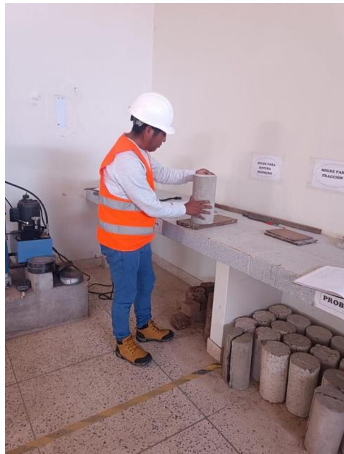
Fotografía N° 08: Ensayo de resistencia a compresión
