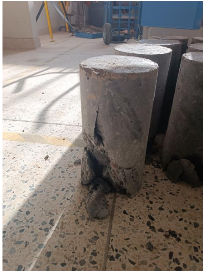
Fotografía N° 13: Rotura de la briqueta
