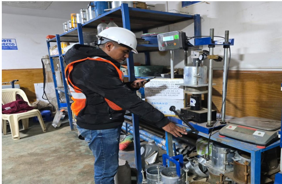
Ensayo de CBR C – 1
