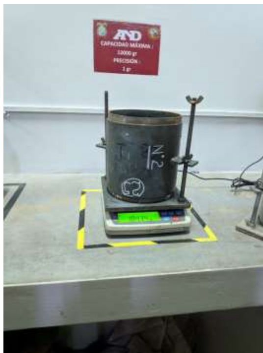
Fotografía 14. Ensayo de Peso unitario.
