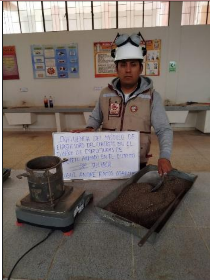
Fotografía 14. Proceso de pesado del molde para la prueba de densidad.
