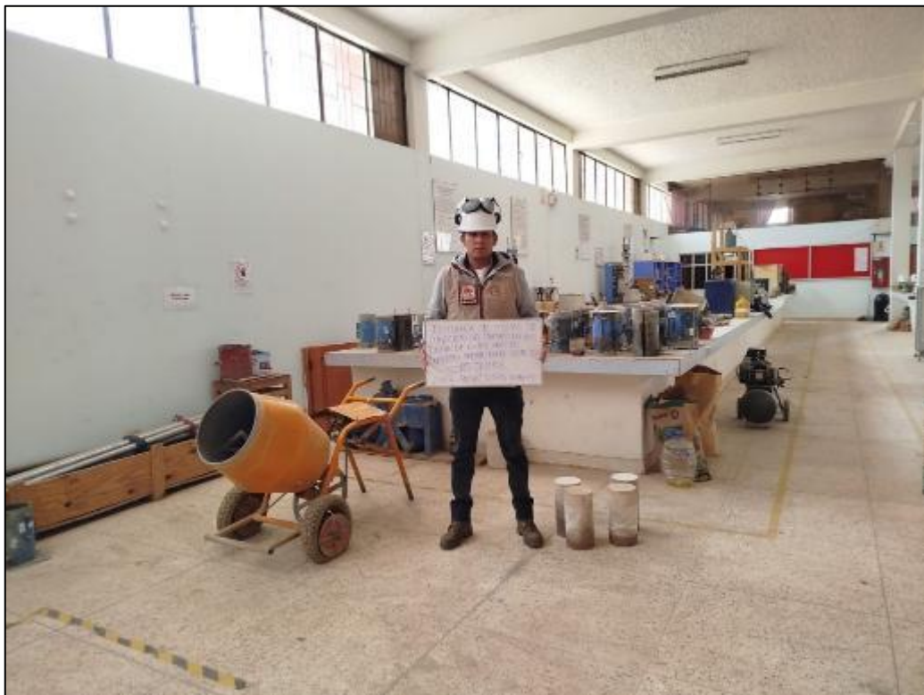
Fotografía 15. Probetas de concreto a los 28 días.
