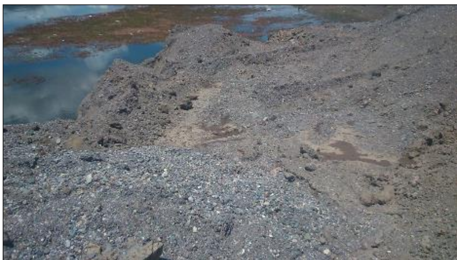
Fotografía 5. Agregado en estado natural con limos y arcillas de la cantera Isla.
