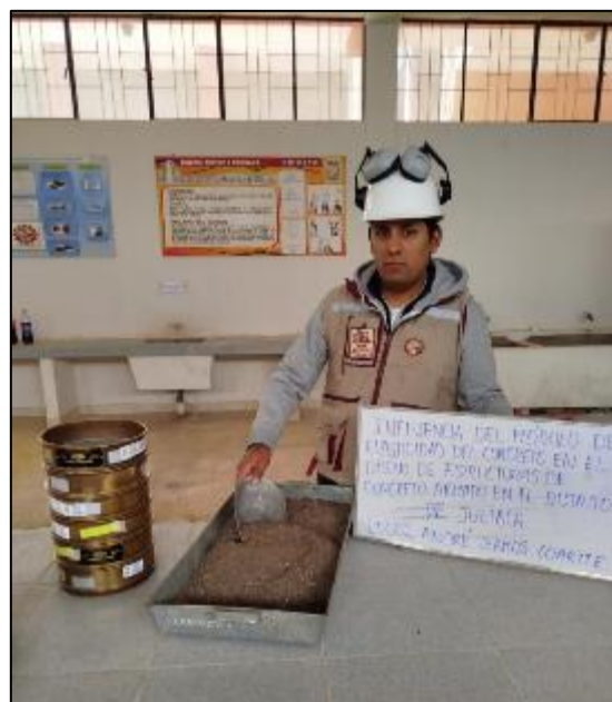
Fotografía 11. Preparación de la muestra para la prueba granulométrica.
