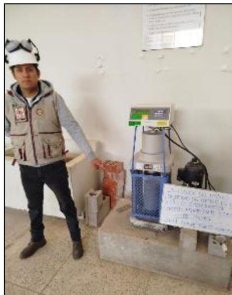
Fotografía 18. Probeta de concreto sometido al ensayo de compresión.
