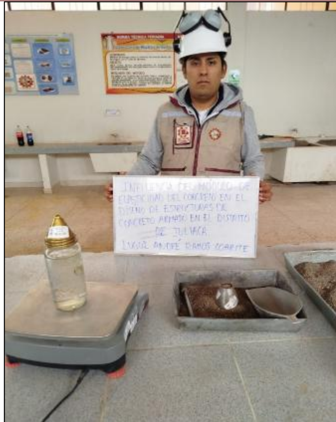
Fotografía 12. Prueba del picnómetro para los agregados.
