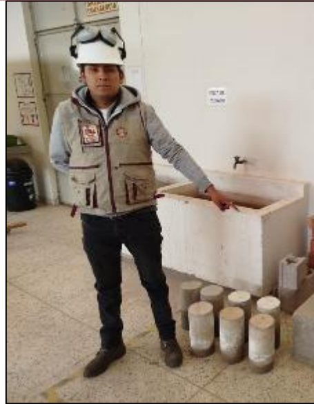
Fotografía 16. Probetas de concreto preparadas para el ensayo de compresión.
