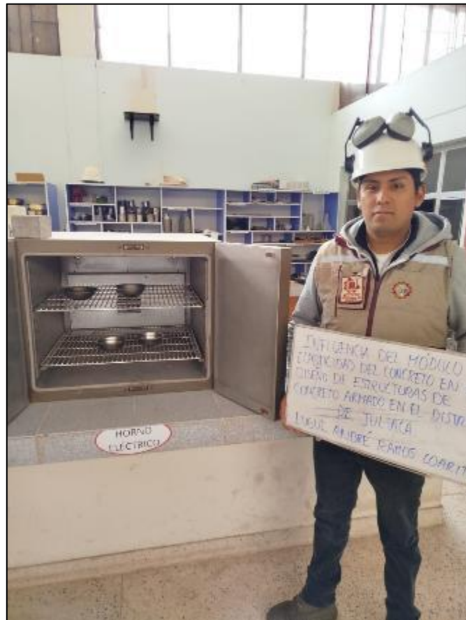
Fotografía 13. Secado al horno de las muestras de agregados saturados.
